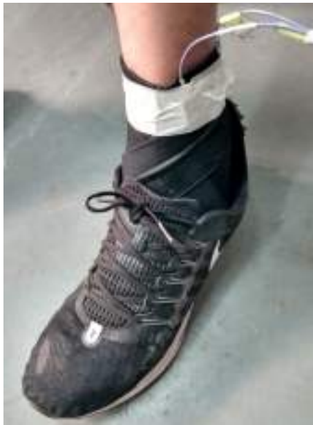
Figura C.2: Acelerómetros axiales, a 90 grados, fijados mediante cinta adhesiva al pie izquierdo del paciente.
