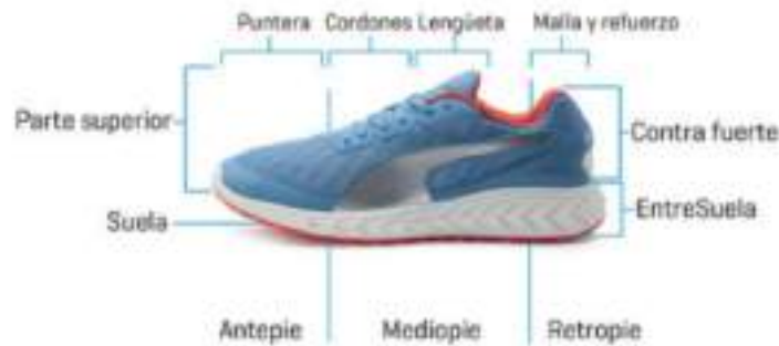
Figura 3.1: Esquematación de las partes que componen un calzado deportivo.
