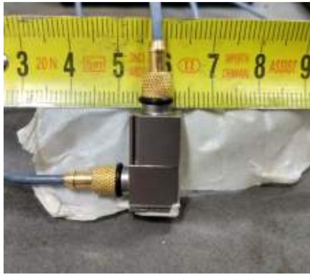
Figura 2.2: Disposición de los acelerómetros axiales para realizar las mediciones.
