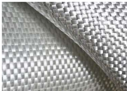
FIGURA 2.2. TEJIDO DE FIBRA DE VIDRIO BIDIRECCIONAL
