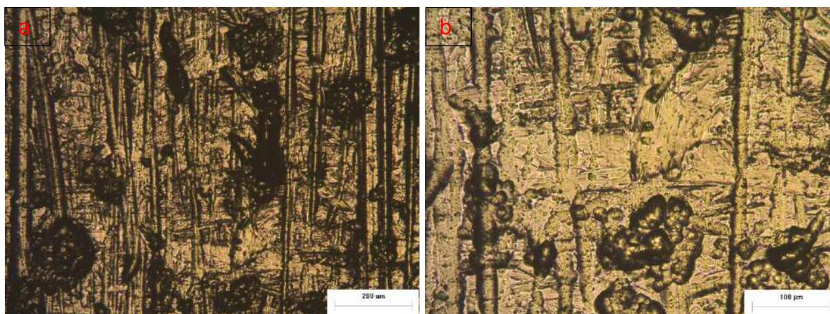
Fig. 65. Imagen microscópica de muestra electropulida con 0,6 A/cm<sup>2</sup>, 60 °C y 7 cm entre ánodo y cátodo: a) aumento 50X, b) aumento 100
