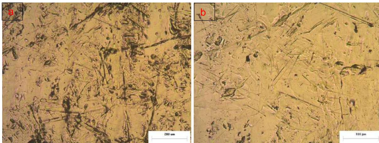
Fig. 53. Imagen microscópica de muestra electropulida con 0,6 A/cm<sup>2</sup>, 45 °C y 5 cm entre ánodo y cátodo: a) aumento 50X, b) aumento 100x
