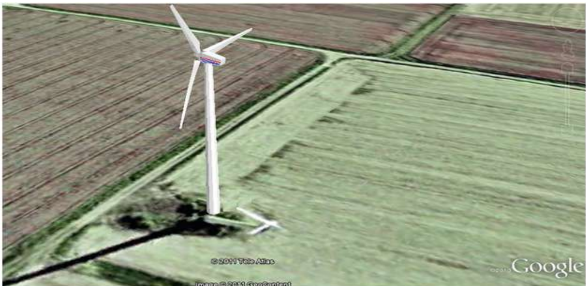
Figura 4.9.2: Imagen en Google Earth del aerogenerador Fuhrländer 2500 (2.5 MW) (Fuente: WindPro-Google Earth)
