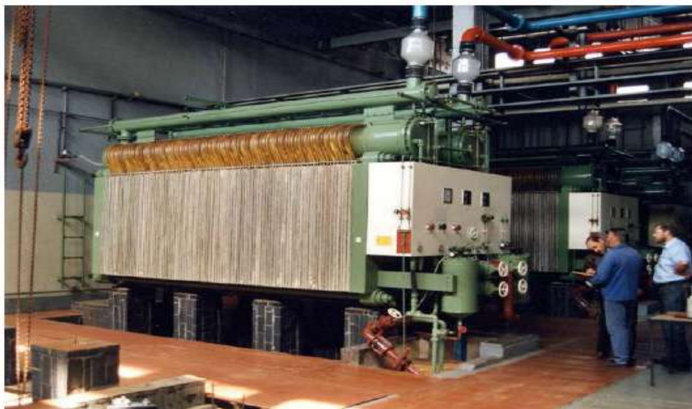
Figura 3.4.3.2 Electrolizador convencional alcalino ELT (Fuente: ELT Elektrolyse Technik GmbH 27 )
