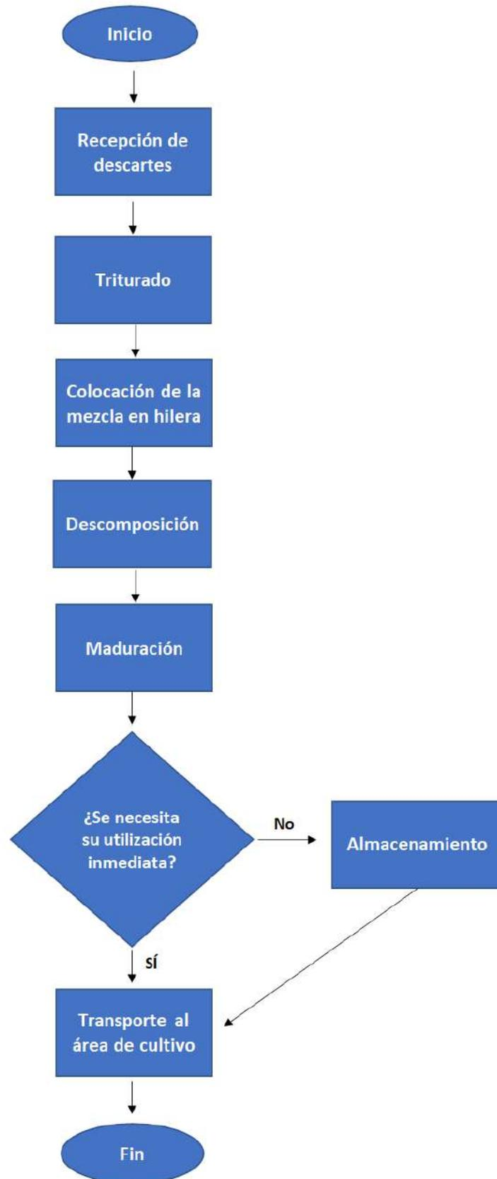
Figura 19: Diagrama de flujo del proceso de compostaje.
