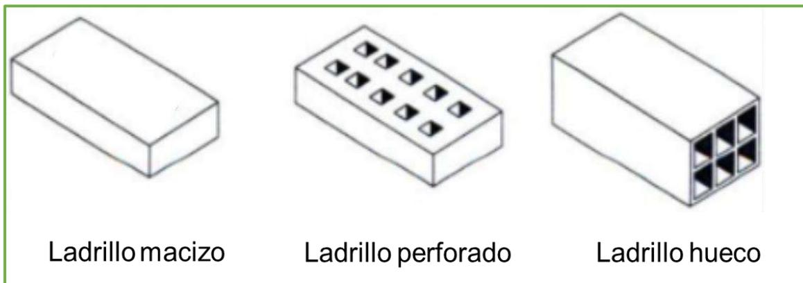
**Figura 4.1.1.** Representación de los diferentes tipos de ladrillos de arcilla roja adaptada del libro “Técnica de la construcción con ladrillo”
