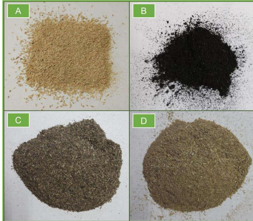
**Figura 3.2.1.** Aspecto macroscópico de: (A) aserrín de pino, (B) char de aserrín de pino, (C) cáscaras de semillas de girasol, (D) residuos de maíz, molidos y tamizados
