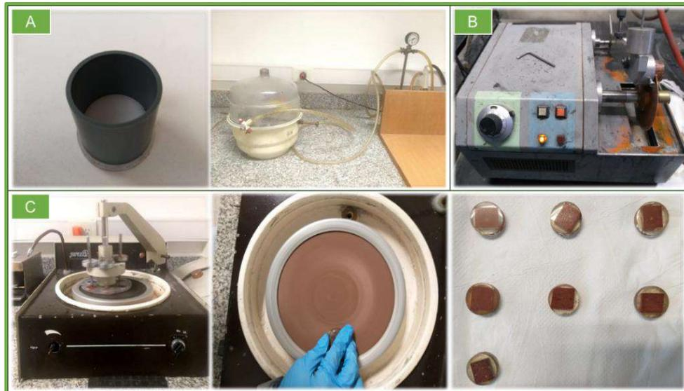
**Figura 4.2.9.** Preparación de las probetas de ladrillo con pulido espejo: (A) embutido de los cubos de ladrillo, (B) corte de las probetas embutidas, (C) pulido de las probetas embutidas
