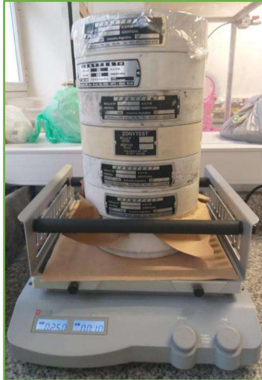
**Figura 4.2.2.** Tamices y agitador usados en la determinación de la distribución del tamaño de partícula de la arcilla y de los residuos de interés
