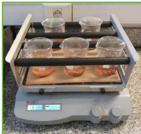
**Figura 4.2.10.** Ensayo de lixiviación de los ladrillos fabricados
