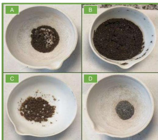
**Figura 3.3.6.** Aspecto macroscópico y cantidad de las cenizas de: (A) aserrín de pino, (B) char de aserrín de pino, (C) cáscaras de semillas de girasol, (D) residuos de maíz
