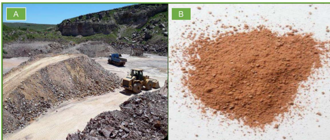
**Figura 4.2.1.** (A) Acopios de arcilla y tierra; (B) aspecto macroscópico de la mezcla de arcilla y tierra, denominada arcilla, empleada en la elaboración de los ladrillos
