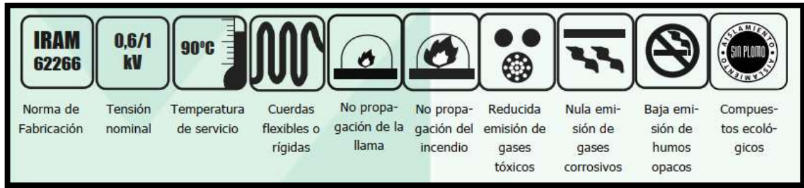
Fig. 16.4. Principales características del cable Afumex 1000.
