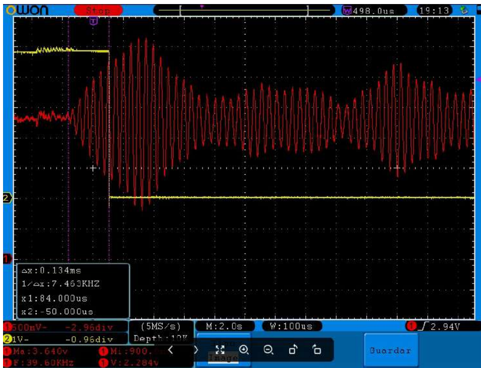
Figura 7.7: Salida comparador de umbral con respecto al pulso recibido y amplificado, con tensión de umbral de 2,8 v.
