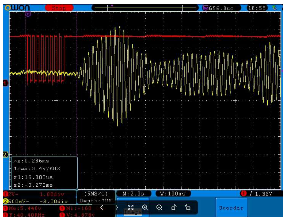
Figura 7.4: Pulso transmitido (roja) y el correspondiente recibido (amarilla).
