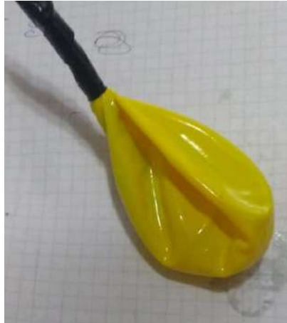
Figura 6.5: Hidrófono construido a partir de un globo relleno de aceite.
