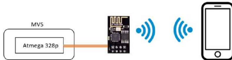
Figura B.2: Comunicación entre el sistema de medición (Atmega328p), el ESP-01 y un dispositivo cliente.
