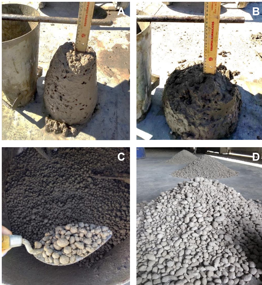
Figura 4. Proceso de conformado de los agregados reciclados. A) Asentamiento inicial; B) asentamiento con la incorporación de superplastificante; C) inmediatamente después del granulado; D) 24 horas después del granulado
