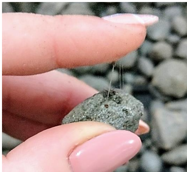
Figura 10. SAP sobre superficie de agregados con baja relación a/c.
