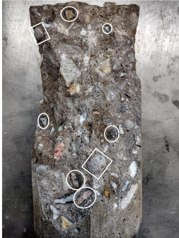
Figura 13. Superficie de probeta con 40% de reemplazo después del ensayo de compresión
