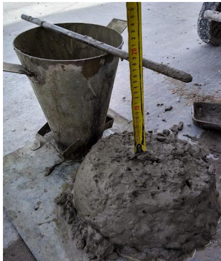
Figura 6. Medida del asentamiento.
