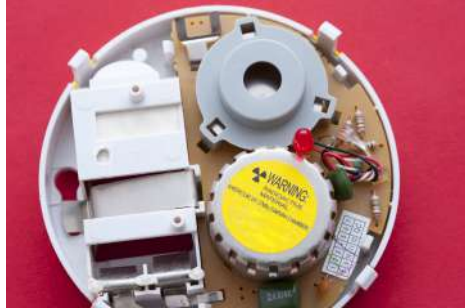
(a) Detector de humo desarmado
