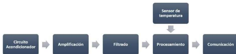
Fig. 4.1: Diagrama en bloque del sistema embebido.
