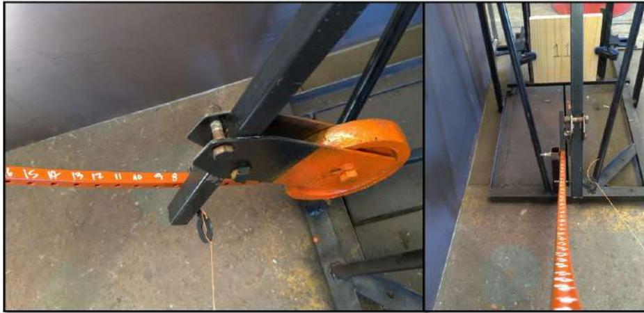
Fig. 5.9: Reglado de alturas y mecanismo de accionamiento.
