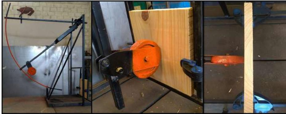
Fig. 5.10: Ensayo Charpy con tabla de pino.
