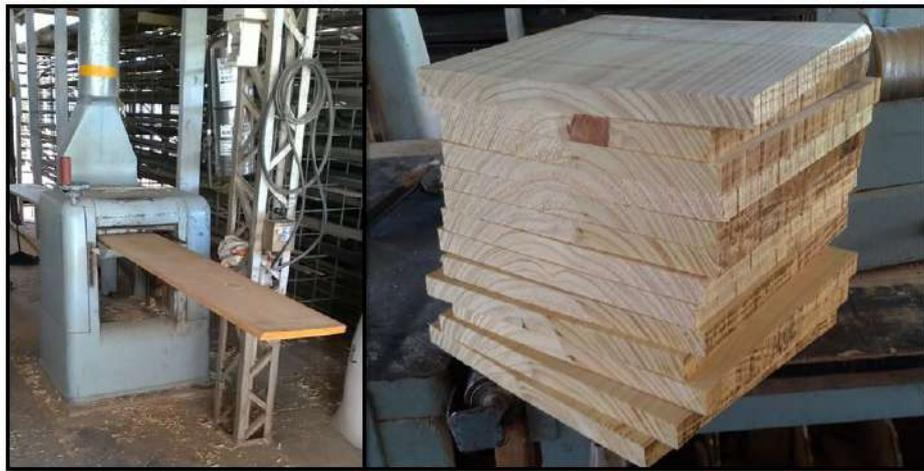
Fig. 5.8: Madera de pino, antes y después del corte y cepillado.
