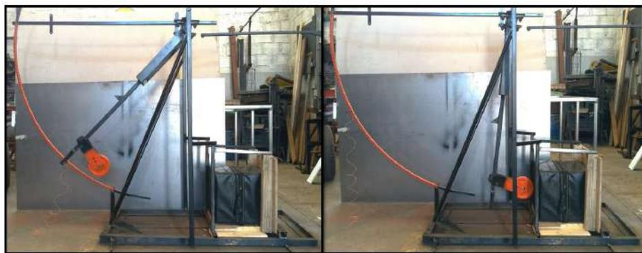
Fig. 5.11: Ensayo Charpy con Smart-Shield.
