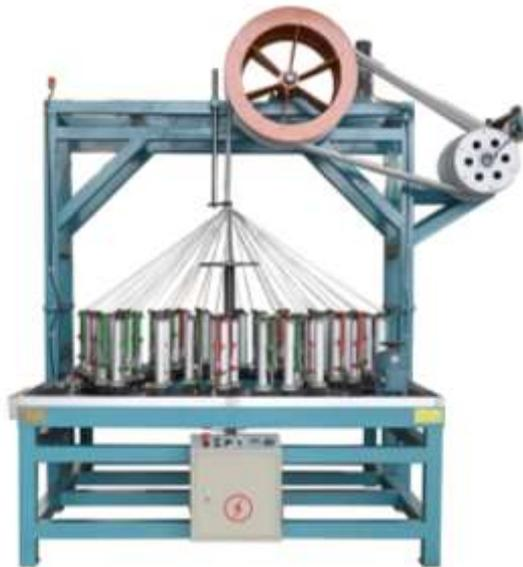
Figura 44. Máquina trenzadora.
