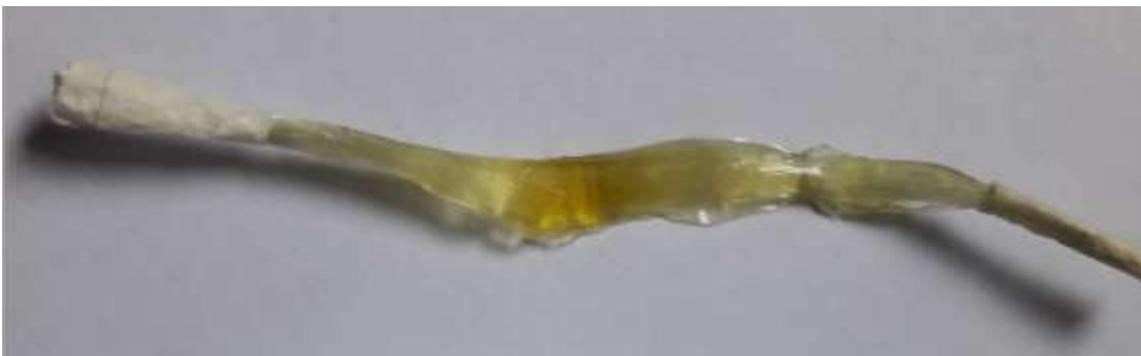
Figura 23. Muestra de mecha de fibra de vidrio impregnada con resina polimerizable en el rango visible con coloración no uniforme.
