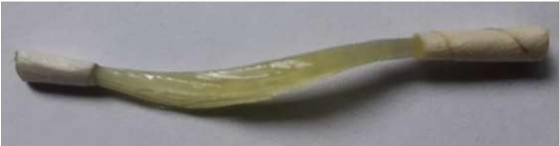
Figura 22. Muestra de mecha de fibra de vidrio impregnada con resina polimerizable en el rango visible.
