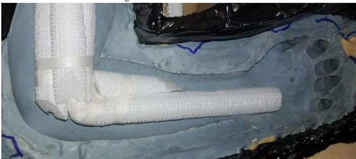
Figura 33. Incorporación de polietileno expandido como material de relleno.
