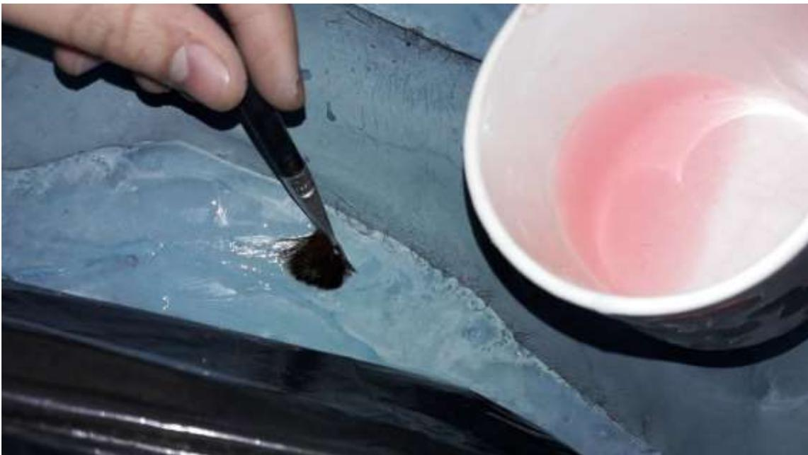
Figura 31. Aplicación de desmoldante.
