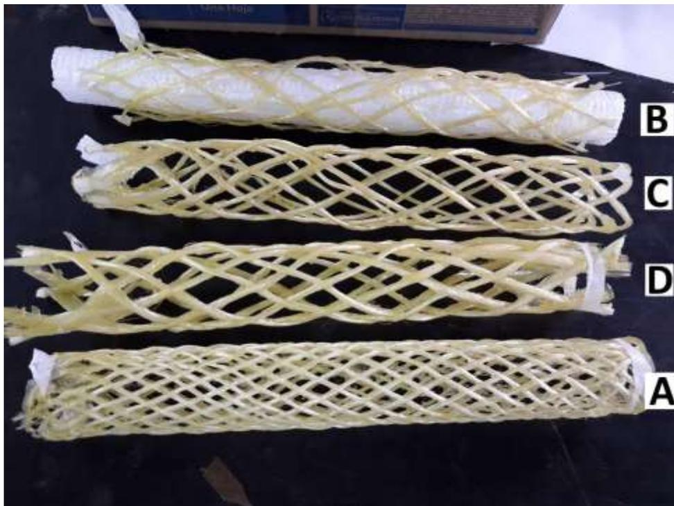
Figura 38. (A) Trenzado simple una mecha, (B) trenzado simple doble mecha, (C) trenzado simple triple mecha, (D) trenzado doble mecha simple.
