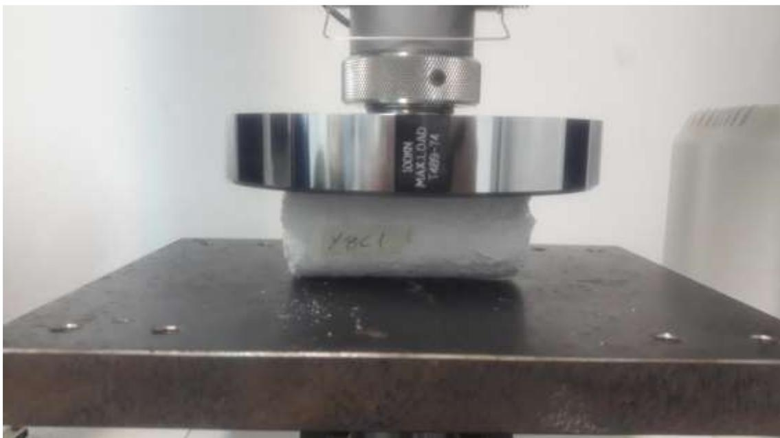
Figura 42. Ensayo de compresión de las muestras de yeso y venda de algodón.
