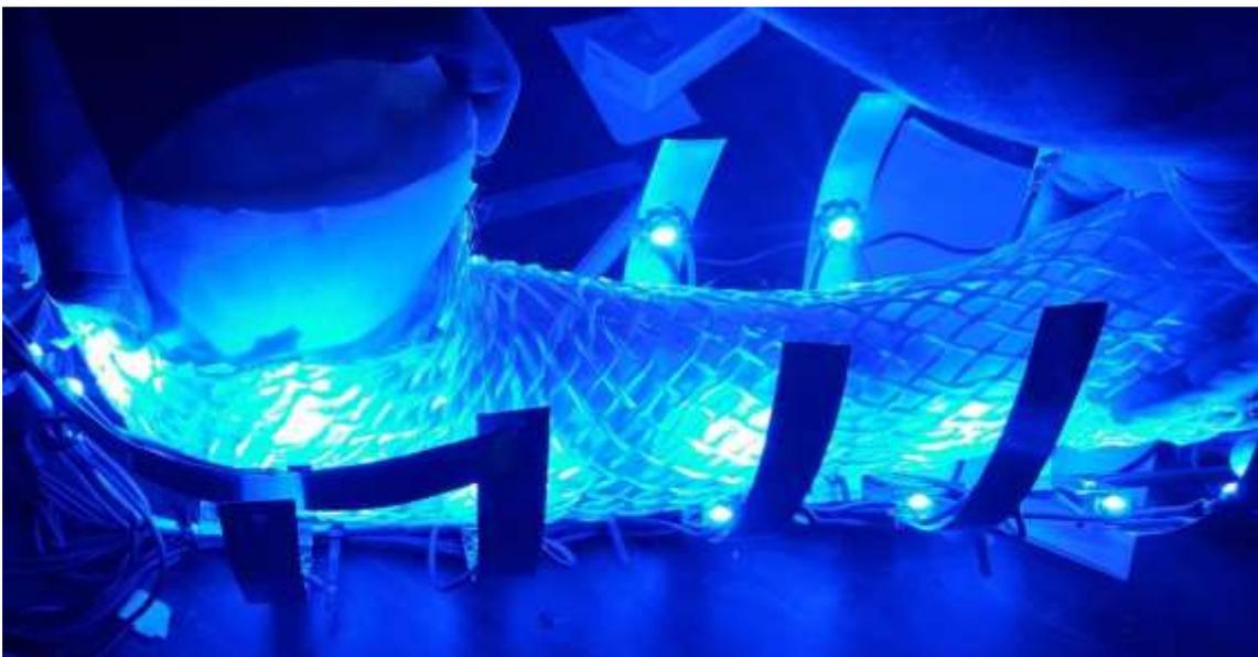
Figura 37. Iluminación con luz azul para lograr el curado homogéneo de la pieza.
