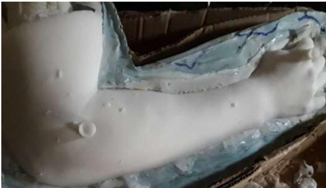
Figura 34. Desmolde luego del curado del caucho de silicona.
