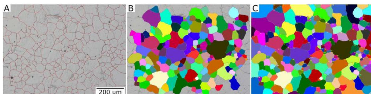
Figura 41. A: superposición de segmentación morfológica 1 y microestructura original; B: medición sin borde; C: medición con borde. Muestra A
