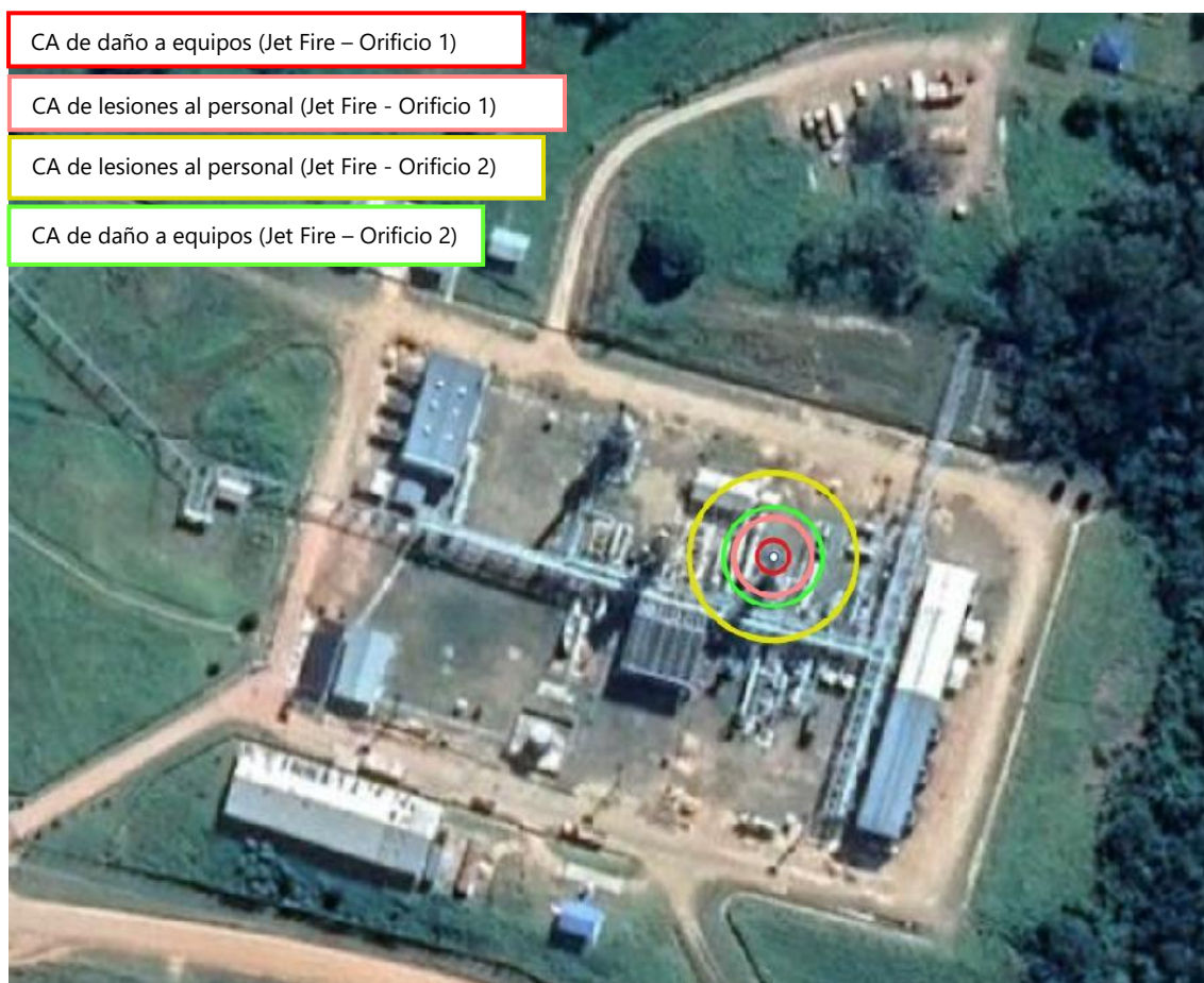
Imagen 4.6. Área de consecuencia por jet fire de lesiones al personal y equipos para orificios 1 y 2.
