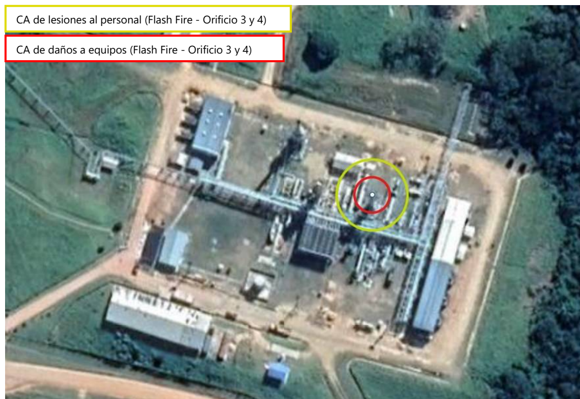
Imagen 4.10. Área de consecuencia para flash fire según orificios 3 y 4, tanto para daños al personal como a componentes.
