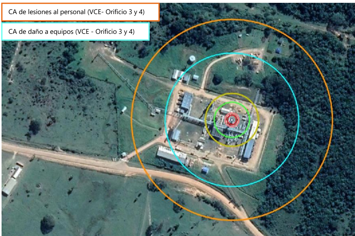
Imagen 4.9. Área de consecuencia para lesiones al personal y componentes para orificios 3 y 4, por VCE.
