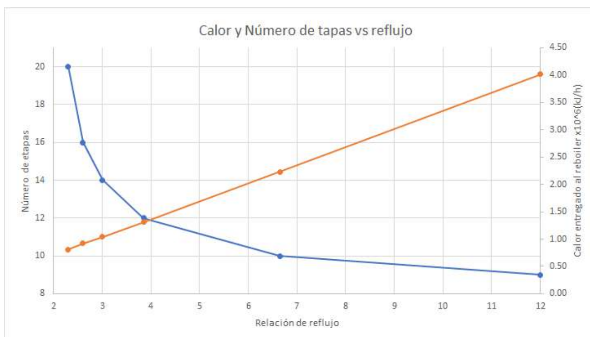
Figura 4.9. Variación del número de etapas y calor entregado versus el reflujo externo.
