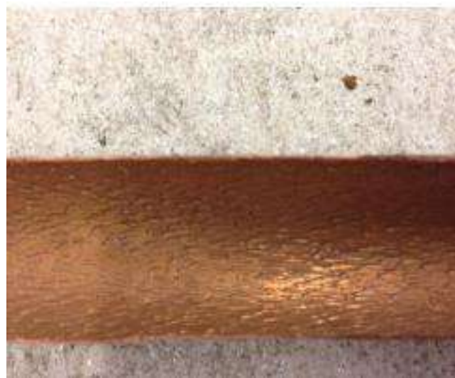
Figura 7.5. Ejemplo de erosión (notar las marcas que se denominan vulgarmente como herraduras de caballo).
