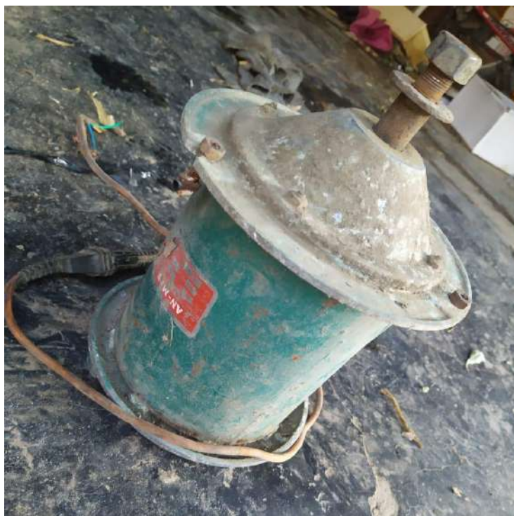
Figura 8.1: Motor de 1 HP y 2800 rpm a utilizar.
