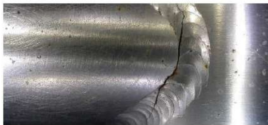
Figura 7.7. Ejemplo de fisuración y su potencial peligro (fractura frágil).
