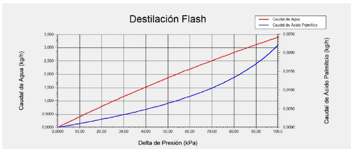
Figura 4.3. Pérdida de agua y ácido palmítico en función de la caída de presión generada en la corriente de entrada.
