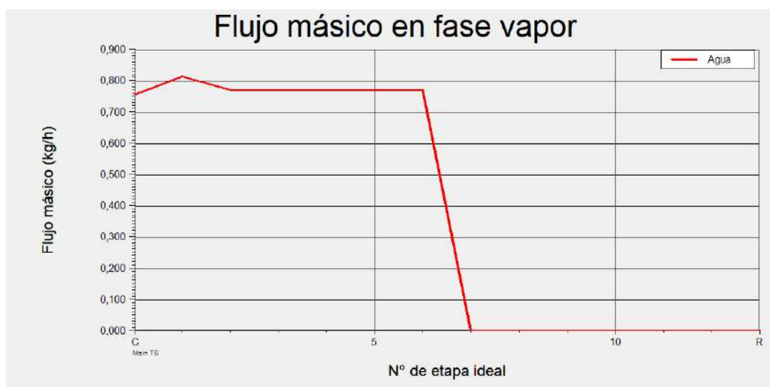
Figura 4.18. Perfil de flujos másicos de agua en estado vapor dentro de la torre.
