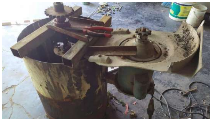
Figura 8.9 : Colocación del motor en el tanque.
