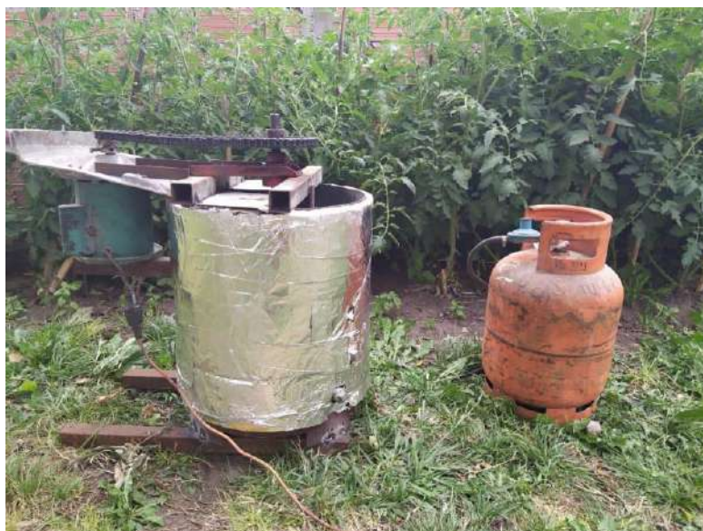
Figura 8.10: Resultado final del reactor tanque agitado.
