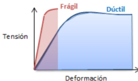
Figura 1. Curvas comparativas entre material dúctil y material frágil.
