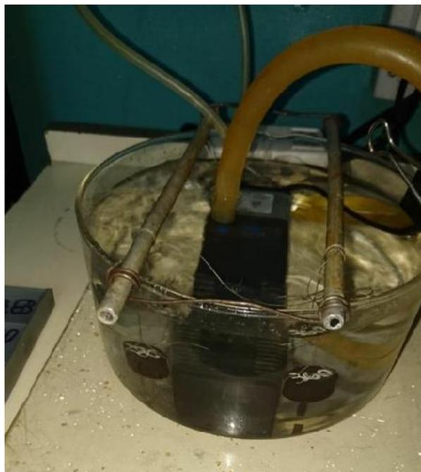
Figura 30. Celda de prueba con muestras testigos.
