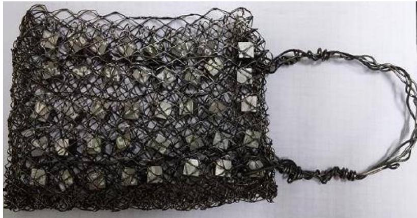
Figura 20. Mallado con muestras previo al tratamiento térmico.
