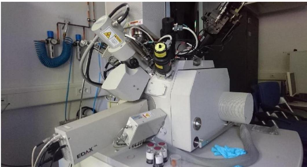
*Figura 26. Equipo FIB/SEM con EDX.*
