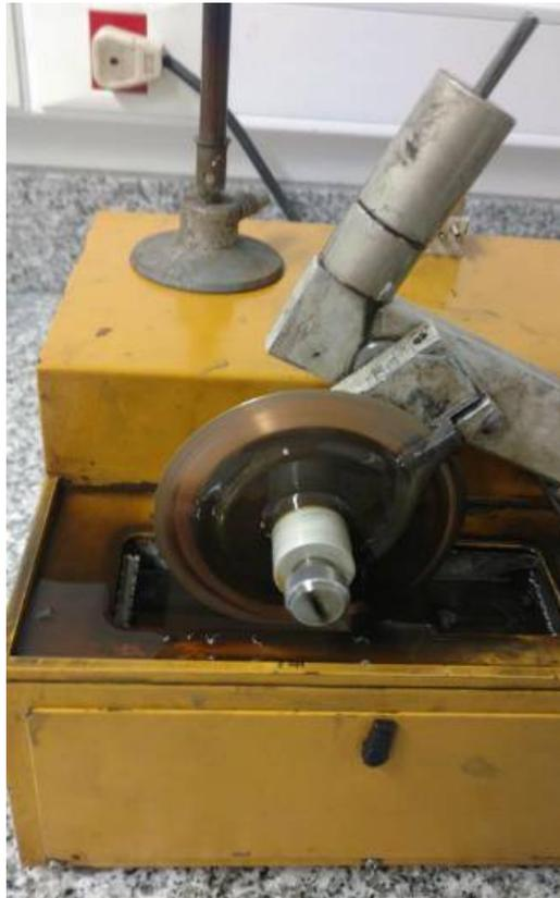
Figura 32. Cortadora metalográfica de disco.
