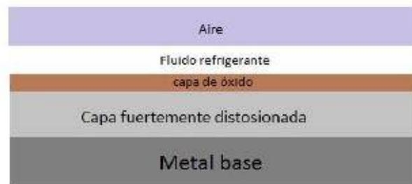
*Figura 14. Interacción de las capas en la zona mecanizada.*
