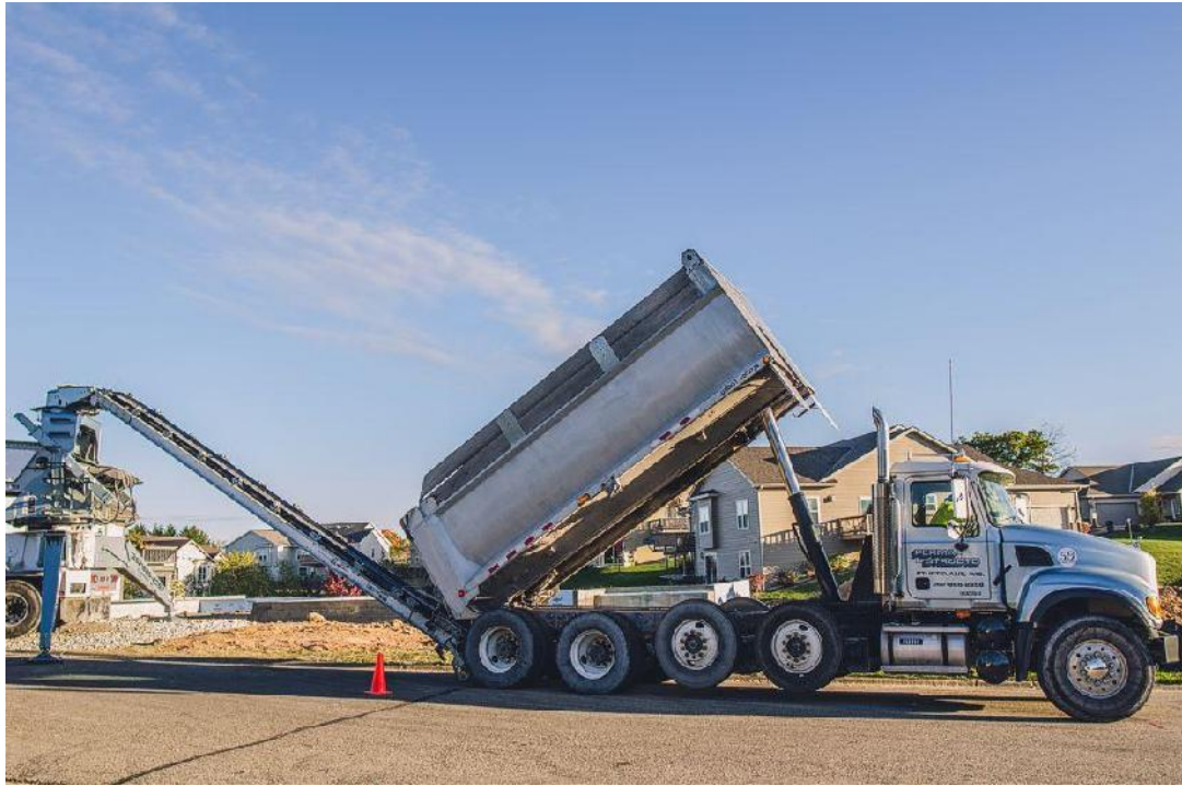
Figura 7: descarga de camión con materia prima hacia cinta transportadora de rodillo. [16]
