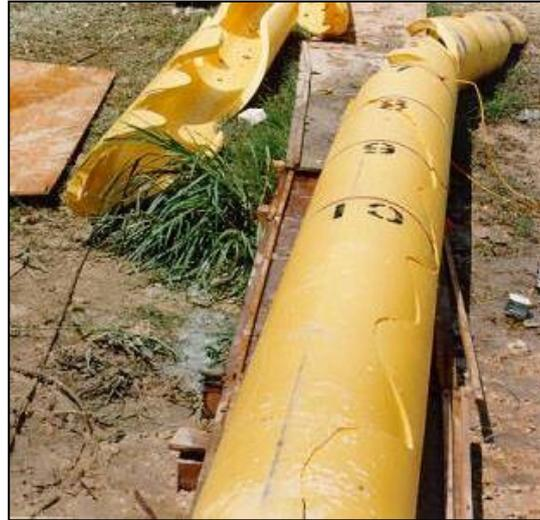
*Fig. 1.2 Fallo por RCP de tubería plástica. [tushnet.blogspot.com (2017)]*
