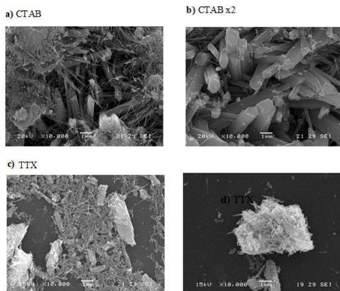
Figura 3.9: Imágenes SEM de muestras sintetizadas a 120 °C y pH 7 con a) CTAB/Ca 2+ (1:1); b) CTAB/Ca 2+ (1:2); c) y d) con TTX, 2 % m/v.
