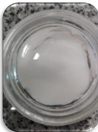
Figura 4.7: Aspecto del gel de \text{TiO}_2 obtenido a partir de la preparación M9
