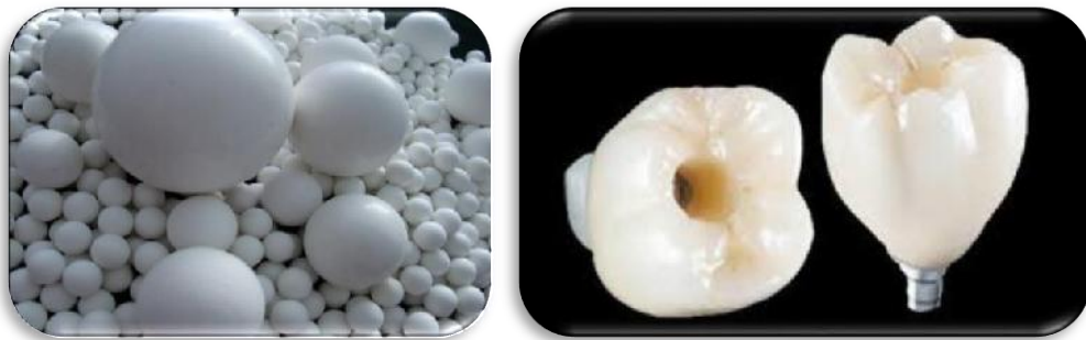
Figura 1.4: Ejemplos de cerámicas inertes, alúmina (izquierda) y zirconia (derecha)
