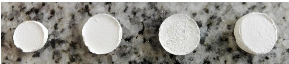
Figura 6.18: Materiales porosos preparados a partir de la dispersión de HA nanométrica obtenida por síntesis hidrotérmica en geles de \text{TiO}_2 , con la adición de PVP, secados con \text{CO}_2 supercrítico y sinterizados a 800°C.
