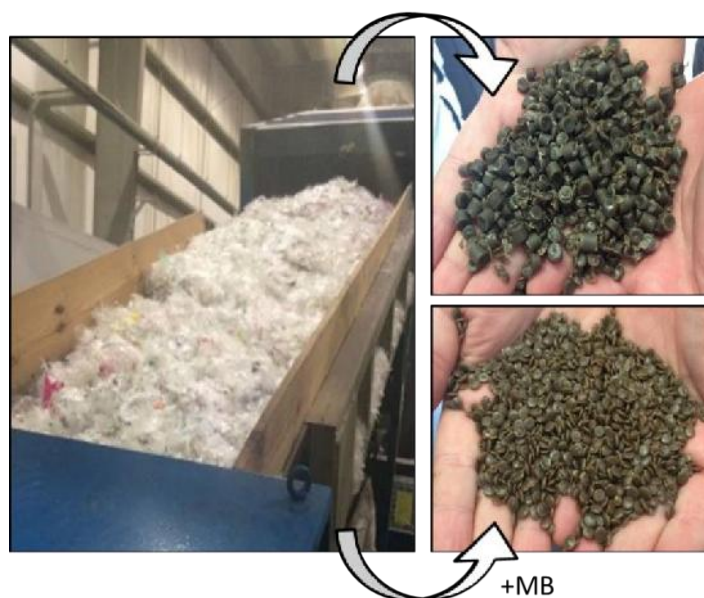
Figura 3-14. Etapas del reciclado de LLDPE/PP post-consumo (PCR).
