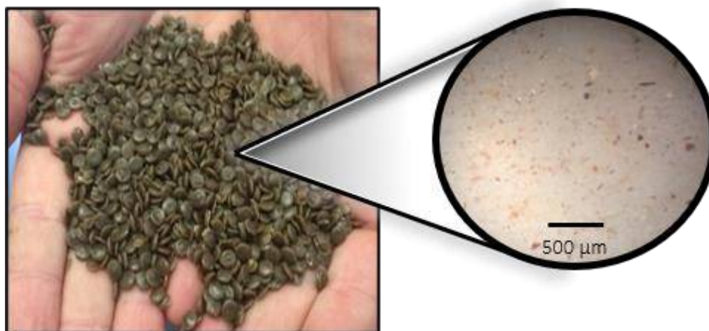
Figura 3-16. Imagen de microscopio óptico de un film perteneciente a mezclas LLDPE/PP recicladas.
