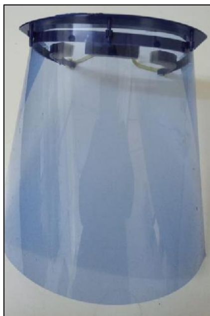
Figura 7-1. Máscara de protección facial fabricada con material reciclado LDPE/PP post-industrial.
