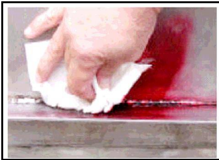
Ilustración 38. Remoción de líquido penetrante
