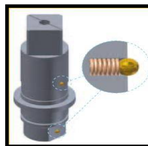
Figura 12. Dispositivo de continuidad eléctrica
