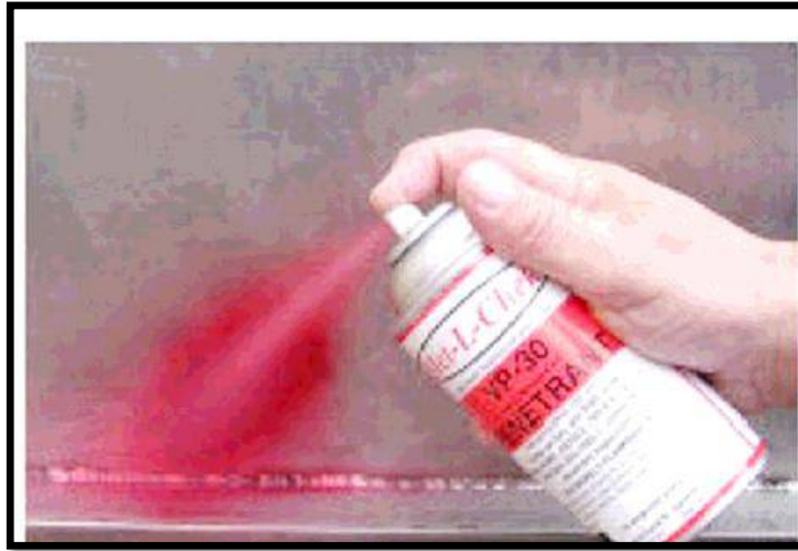
Ilustración 37. Película de líquido penetrante
