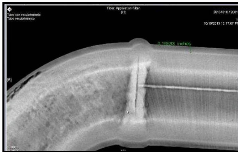
Ilustración 34. Radiografía tubería 3" recubierta
