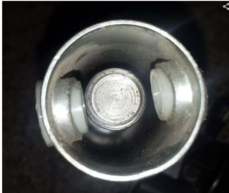
Figura B.6: Se observa el interior del actuador y el ancho de las secciones metálicas donde se aloja el perno. Diámetro exterior actuador 35 mm.
