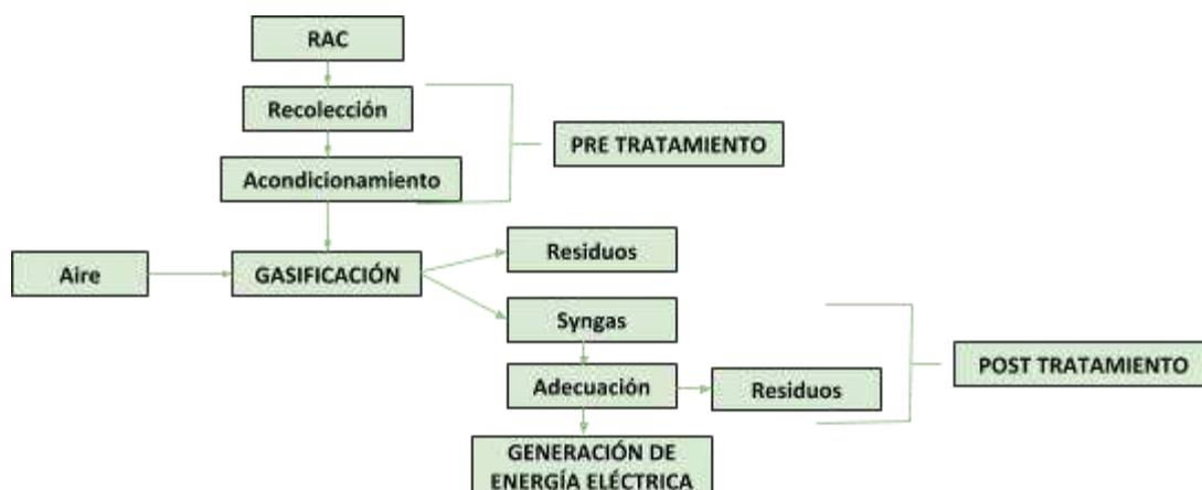
*Figura 1.5. Diagrama del proceso de producción de gas de síntesis para la generación de energía eléctrica.*
