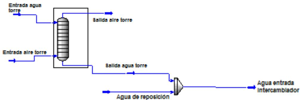
Figura 8. Torre de enfriamiento y recirculación del agua al intercambiador agua-syngas
