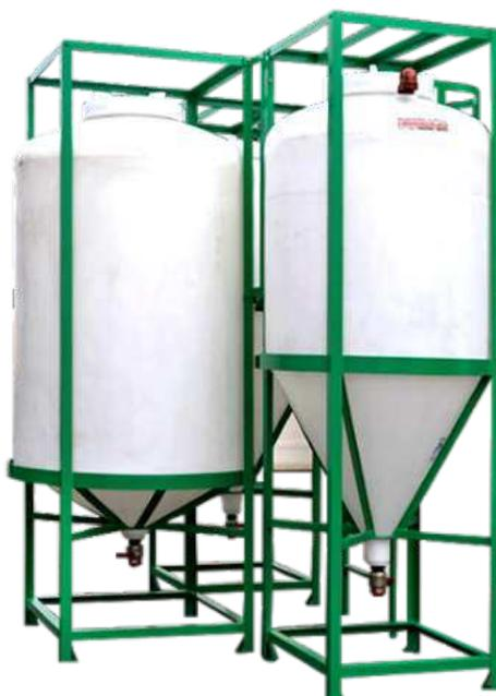
*Figura 6.19. Tanque de almacenamiento de cenizas*
