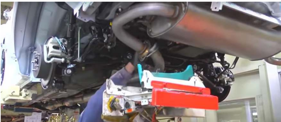
Figura 10: Operación con carrocería suspendida (conexión del sistema de escape)
