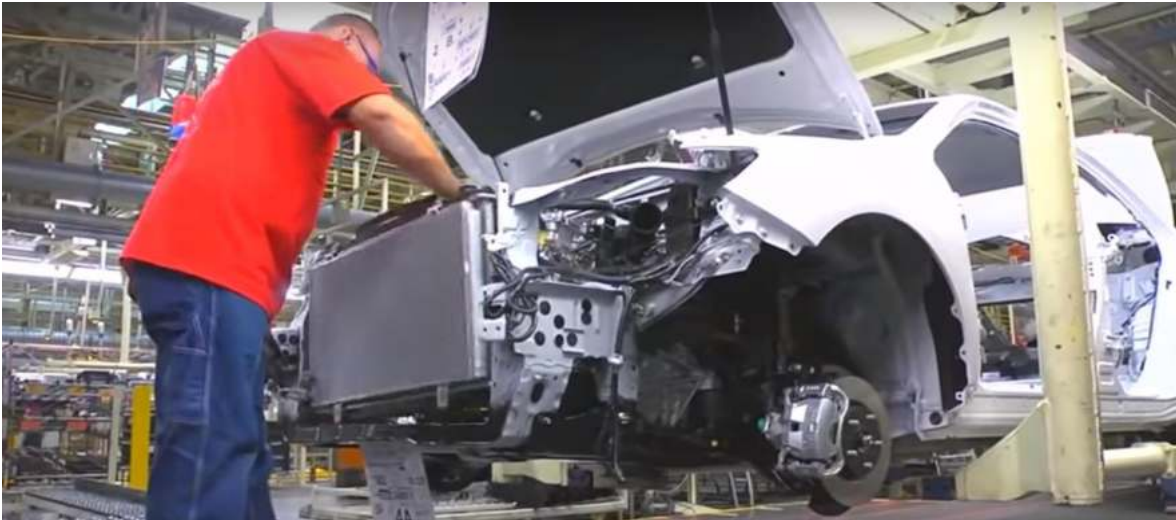
Figura 11: Operación con carrocería suspendida (instalación del radiador)
