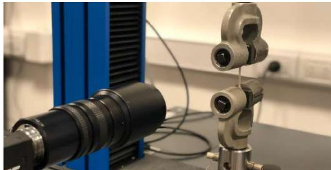
Figura 4.2: Ensayos de tracción uniaxial con Correlación Digital de Imágenes (DIC). La obtención del campo de deformaciones de la probeta permite establecer la deformación real de la probeta en su punto de encuellamiento, donde consecuentemente se produce la rotura.
