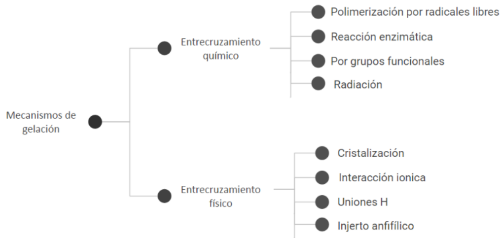
Figura 2.1. Clasificación de los mecanismos de gelación para hidrogeles.
