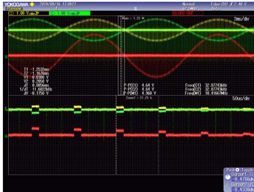
FIGURA 4.7: Visualización del muestreo de cada canal en la entrada del ADC.
