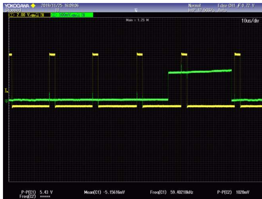
FIGURA 4.8: Flancos de la señal de CS dentro de un canal seleccionado.
