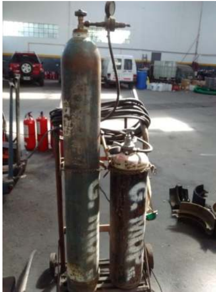
Ilustración 7. Soldadora oxiacetilénica utilizada por el personal del Taller.
