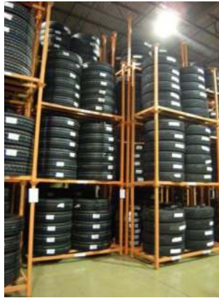
Ilustración 50. Rack para almacenar neumáticos. Fuente: Página Web Martins Industries, 2019.
