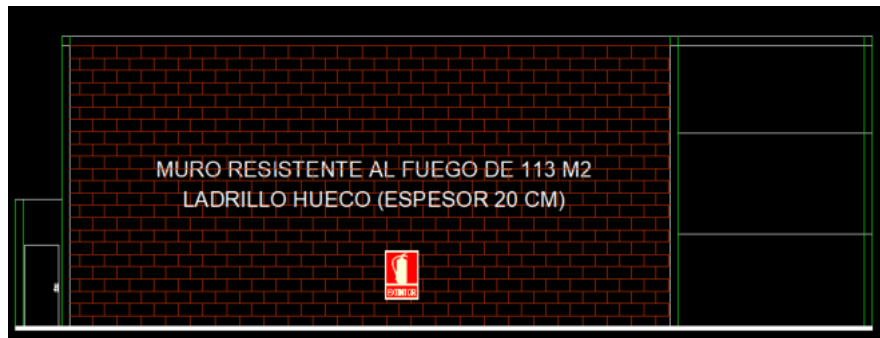
Ilustración 60. Muro resistente al fuego en el sector Taller. Fuente: Elaboración propia a partir del plano de la empresa.
