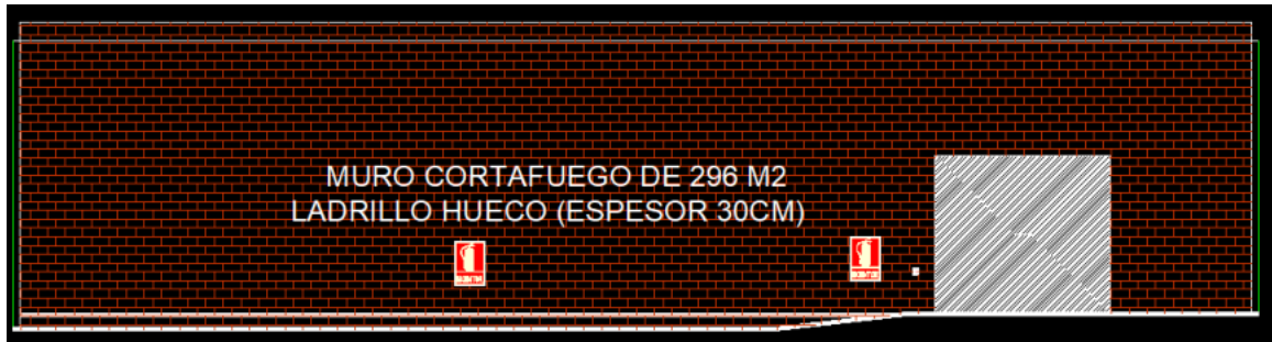
Ilustración 67. Muro cortafuego del sector de Depósito de neumáticos y mercadería. Fuente: Elaboración propia a partir del Decreto 351/97, e información suministrada por la empresa.
