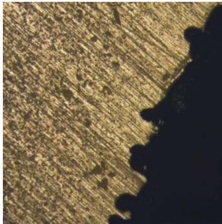
*Imagen 1. Microscopia de ensayo de picado de acero al carbono sumergido en 24 hs SAA+ 2 hs SAA+Cl*
