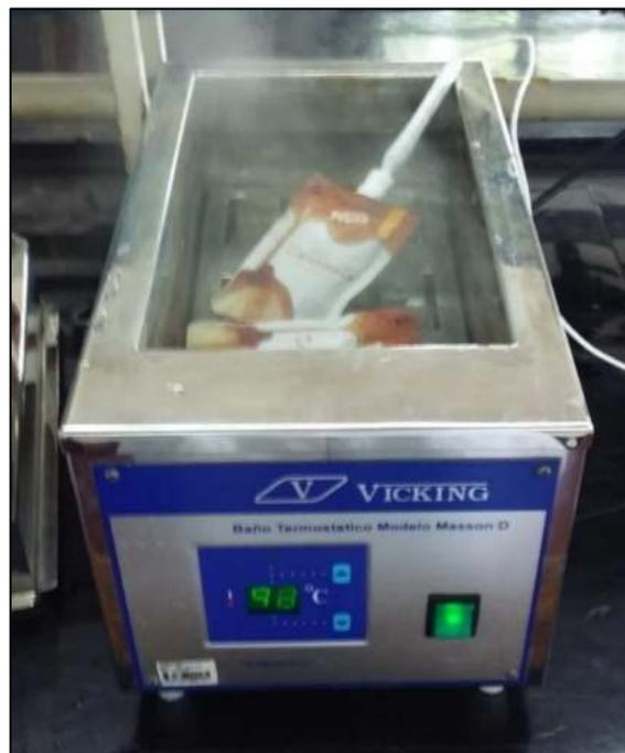
Figura 5.2: Baño termostático con muestras de puré.
