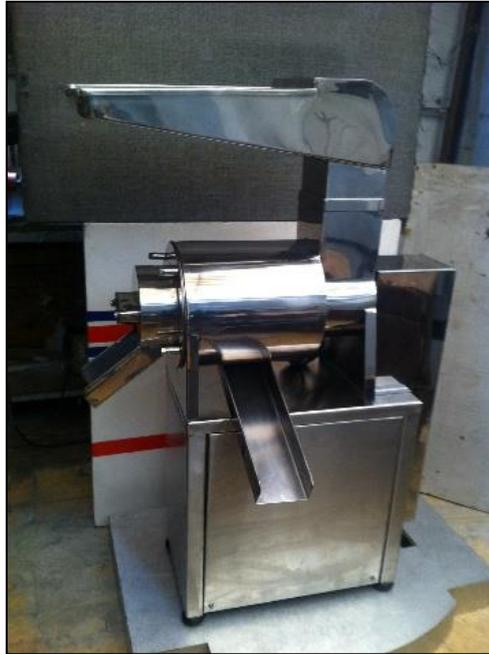
Figura 7.6: Despulpadora.
