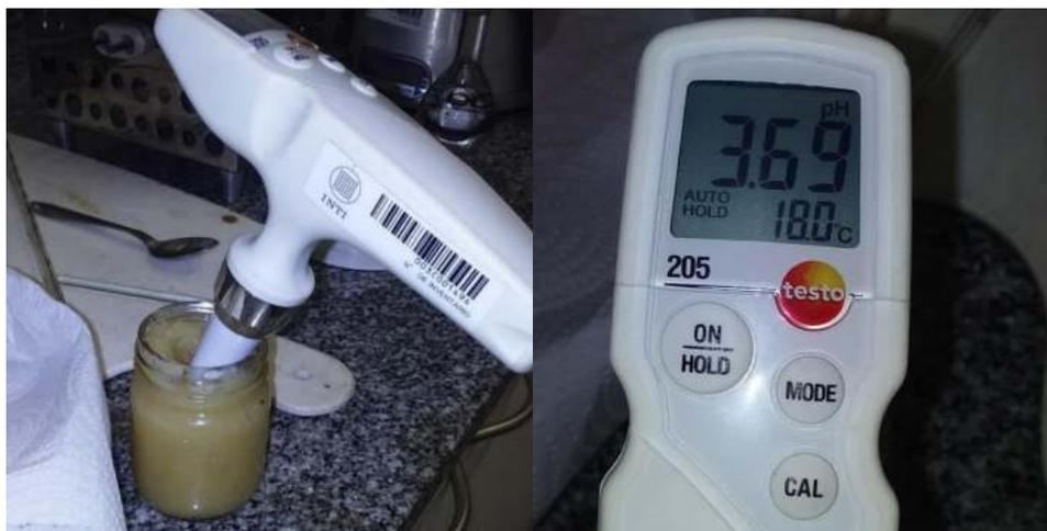
Figura 2.1: Medición de pH de muestras de puré de manzana.
