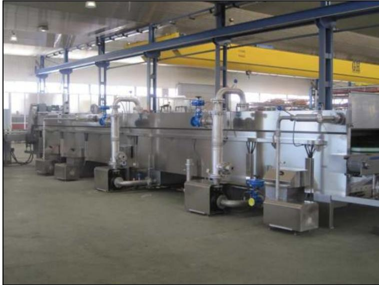
Figura 7.10: pasteurizador de túnel.
