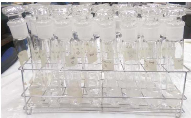
**Figura 2.7** Preparación de muestras para los ensayos de migración global.
