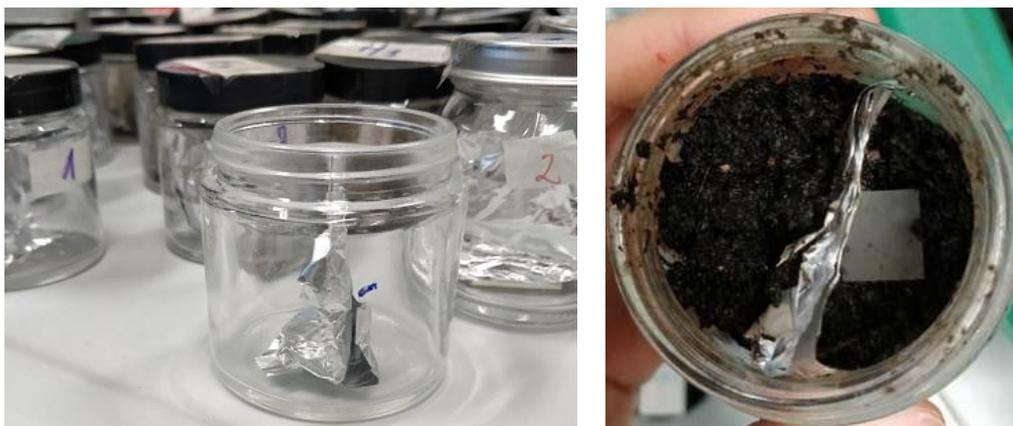
**Figura 2.8** Preparación de muestras para los ensayos de desintegración bajo condiciones de compostaje.
