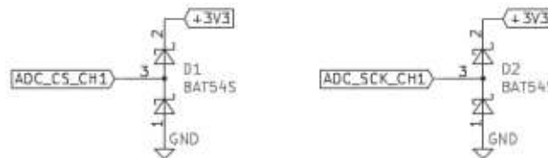
Figura 3.37: Diodos de protección entradas digitales de ADC
