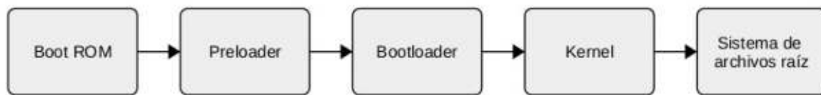
Figura 5.1: Secuencia de arranque para el caso de sistema operativo (Linux)
