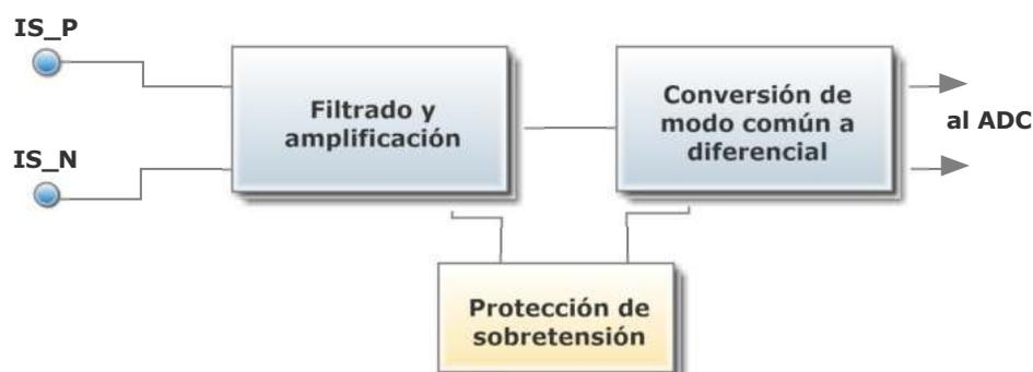
Figura 3.3: Detalle del bloque de acondicionamiento
