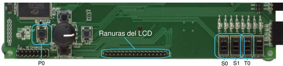
Figura 5.2: Pulsador y botones de configuración de la FPGA
