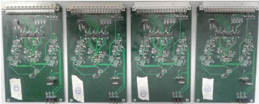
Figura 3.15: Placas de adquisición terminadas
