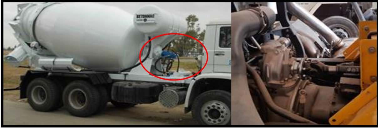
Figura 2: Camión hormigonera con sistema hidráulico (izquierda)/toma de fuerza (derecha). Fuente: Betonmac S.A. (2019, Adaptada).
