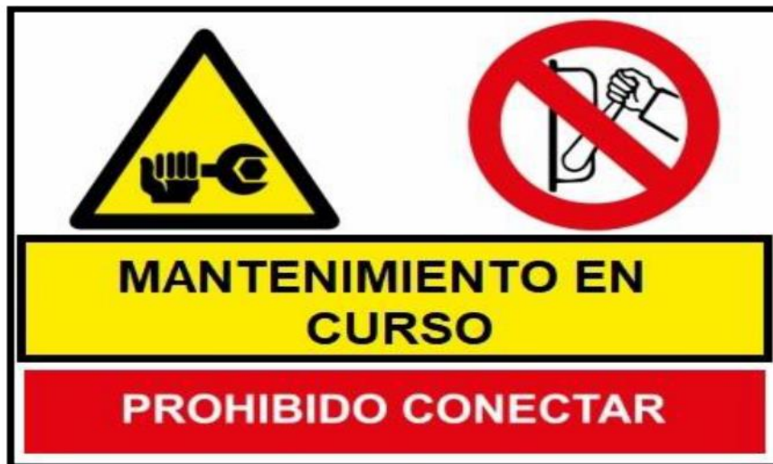
Figura 1: Señalización de seguridad para bloqueo de equipos.
