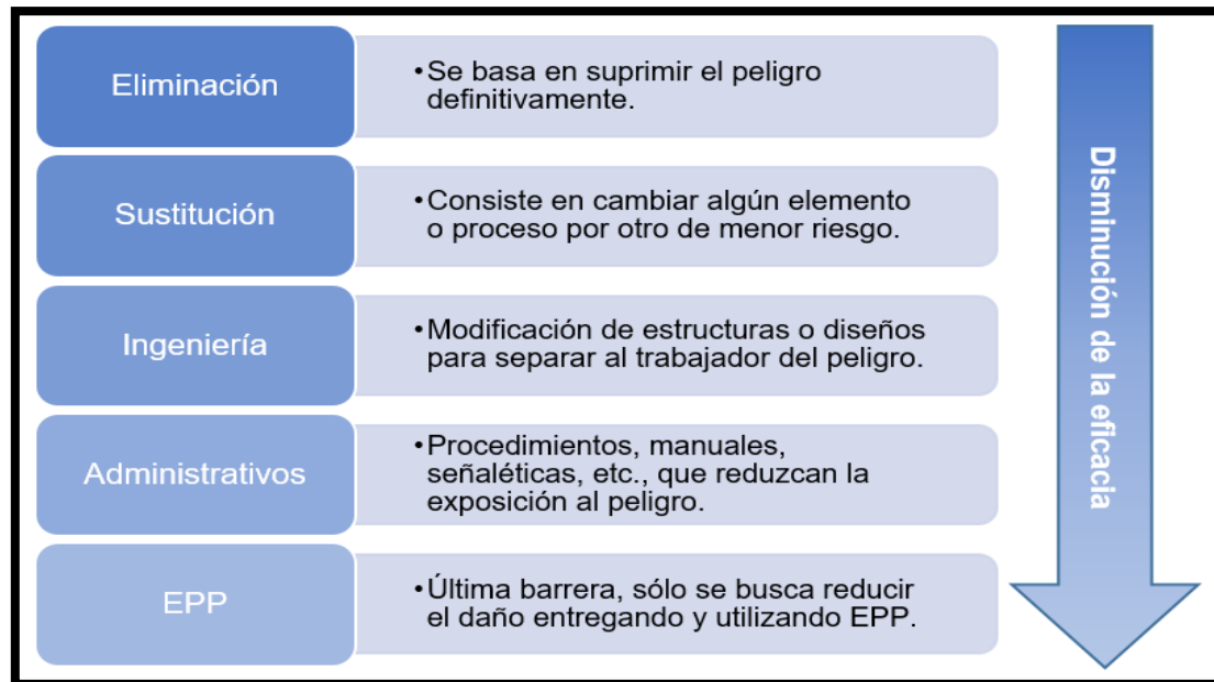
Figura 17: Clasificación de medidas de control. Fuente: Cátedra Seguridad, Higiene y Medio Ambiente (2018).
