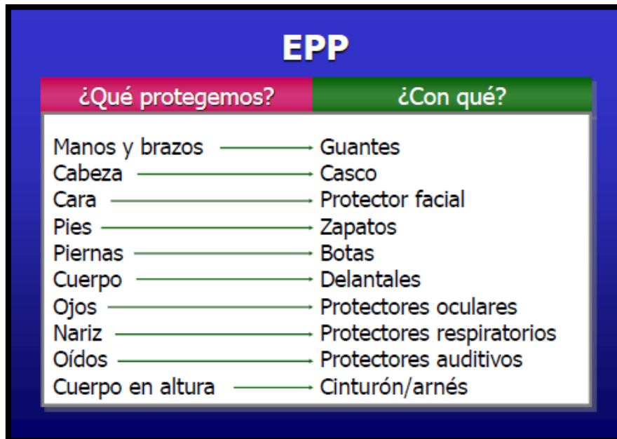
Figura 18: Elementos de protección personal. Fuente: Cátedra de Seguridad, Higiene y Medio Ambiente (2018).
