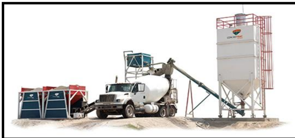
Figura 9: Planta dosificadora de hormigón. Fuente: Sitsa (2019).
