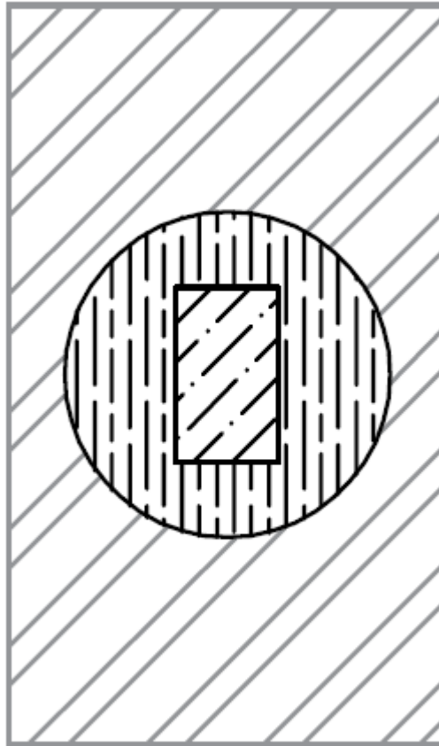
Figura 7.19 - Vista superior, chapa, campana y columna.
