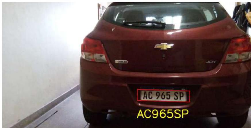
Figura 3.7: Patente reconocida, resultante de la aplicación de un sistema ALPR.
