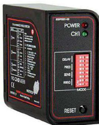
Figura 4.9: Detector magnético utilizado.
