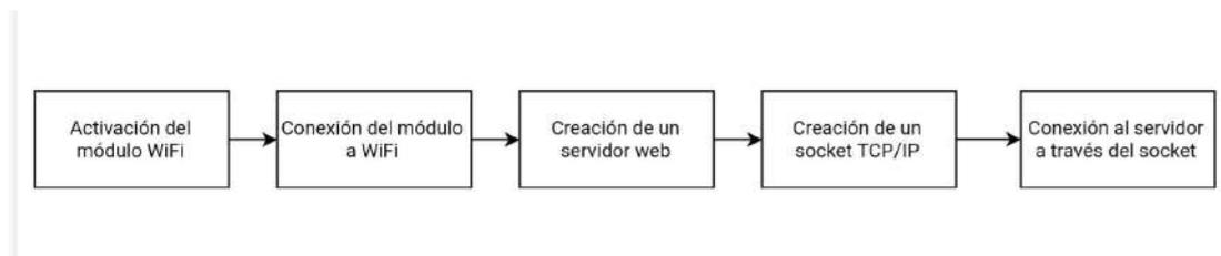
Figura 5.2: Diagrama de flujo representativo de la fase de conexión del sistema.
