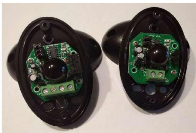
Figura 4.7: Barrera infrarroja utilizada: receptor (izquierda) y transmisor (derecha).
