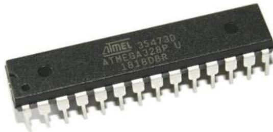
Figura 4.1: Microcontrolador Atmega328P utilizado.
