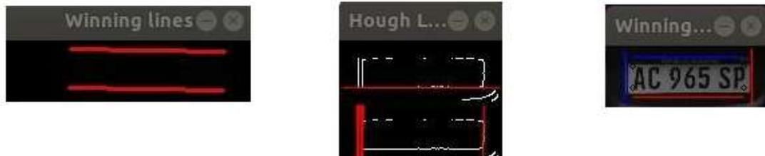
Figura 3.19: Detección de bordes horizontales (a) y verticales (b), y detección de patente (c).
