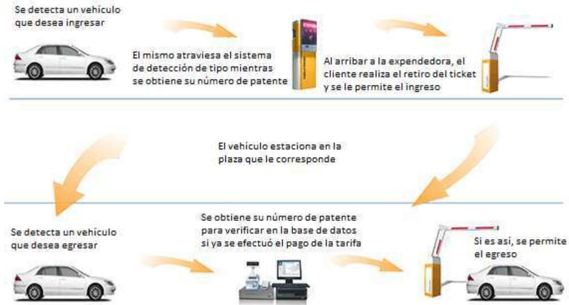
Figura 2.2: Esquema general de funcionamiento del sistema.
