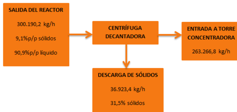
Figura 5.4. Balance de masa en centrífuga tipo decantadora.
