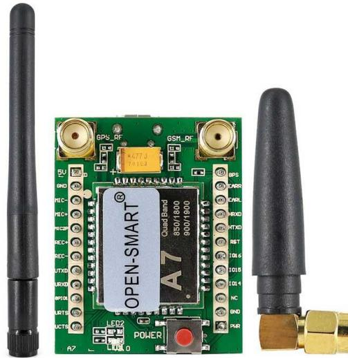
Figura 3.1.3.4.1 – Módulo A7 Ai Thinker GPS+GPRS
