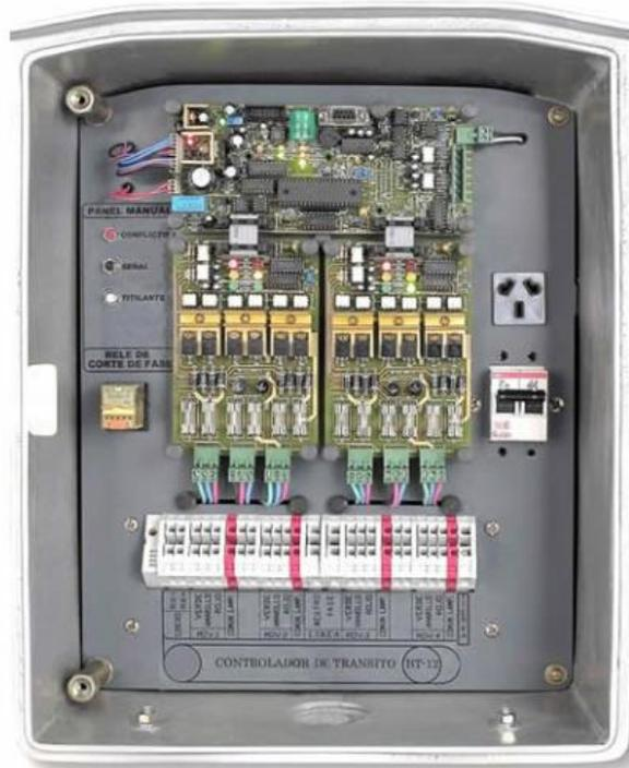
Figura 0.2 – Controlador de semáforos de la empresa Nortelec Servicios S.R.L
