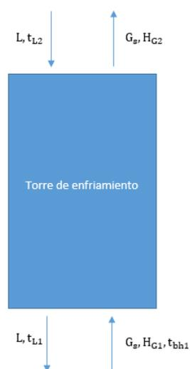
Figura 8.22 – Esquema de una torre de enfriamiento.
