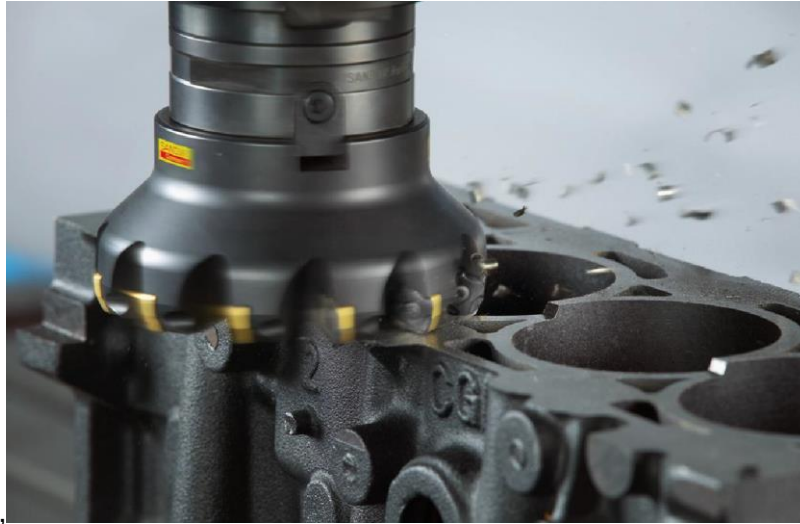
Figura 4: Operación de planeado de block de automóvil con fresa marca AB Sandvik Coromant.
