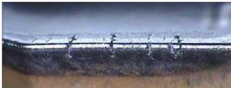
Figura 7: Filo de corte con comb cracks generadas durante operaciones de fresado. Imagen por cortesía de AB Sandvik Coromant.
