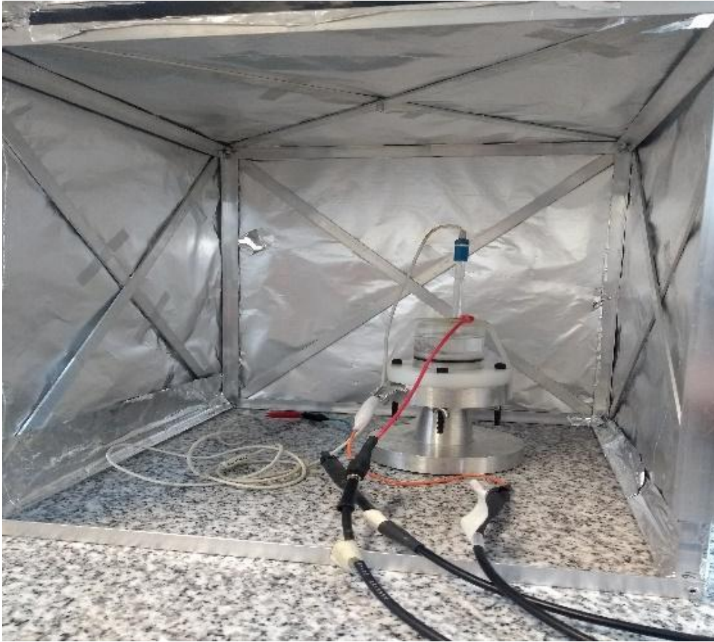
Figura 14: Celda de tres electrodos en funcionamiento dentro de la jaula de Faraday.
