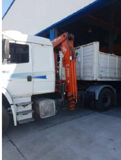
Figura 28: Camión con brazo hidráulico
