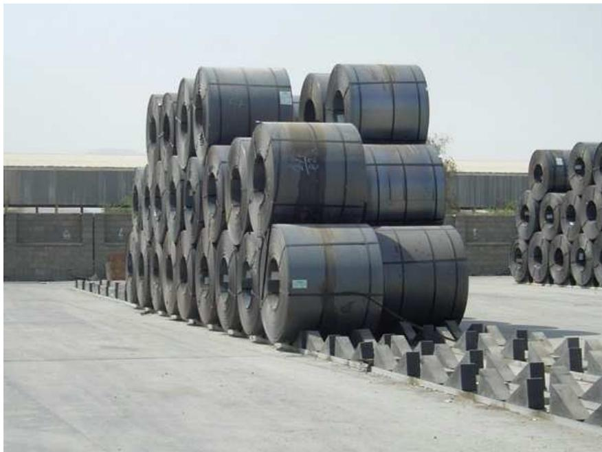
Figura 49: Sistema Rolblock de almacenamiento de bobinas
