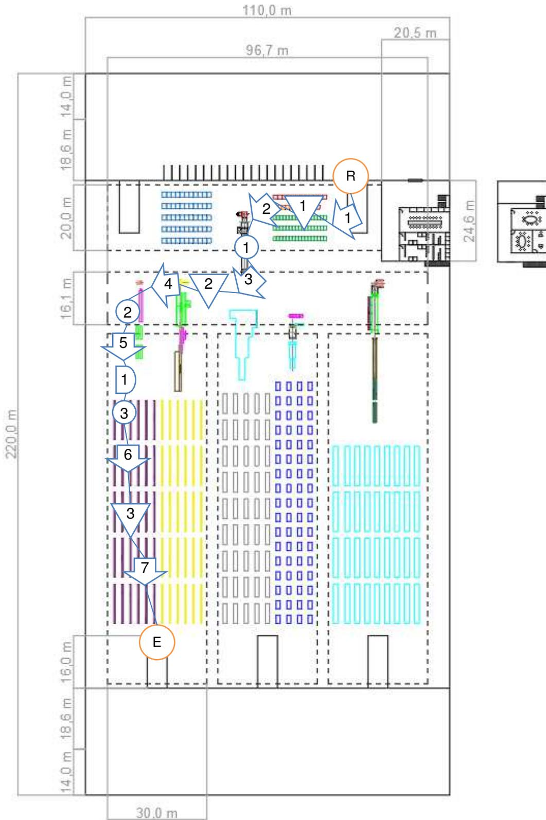
Figura 57: Diagrama de recorrido perfiles (línea china) nueva distribución
