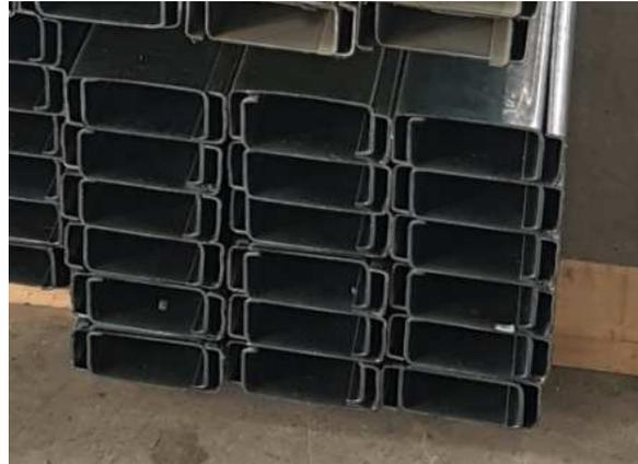
Figura 54: Forma de apilación de perfiles C
