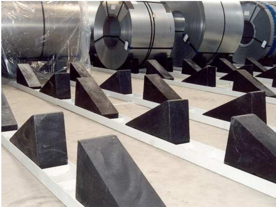
Figura 48: Sistema Rolblock de almacenamiento de bobinas
