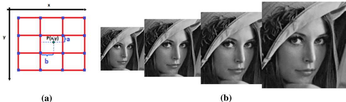
**Fig. 2.6:** Interpolación bicúbica. (a) Representación geométrica para el cálculo del nuevo píxel. (b) Imagen de Lena deformada en el espacio de escala usando interpolación bicúbica.
