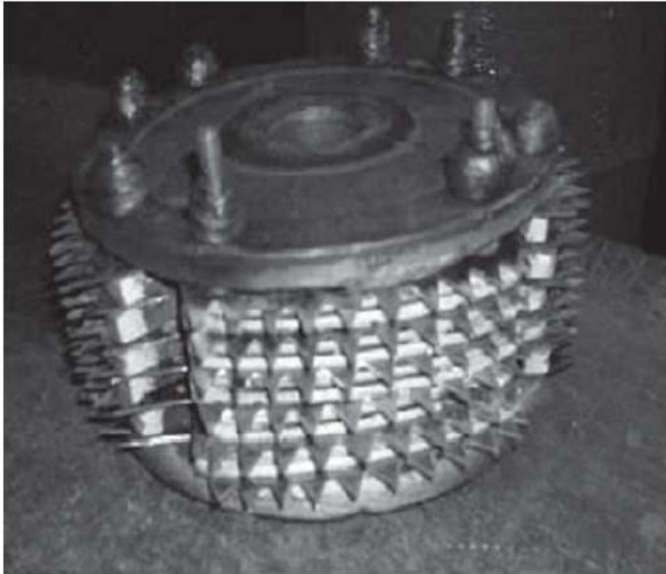
Figura 3,5 montaje de la herramienta de pulido del neumático hecho del acero de alta velocidad
