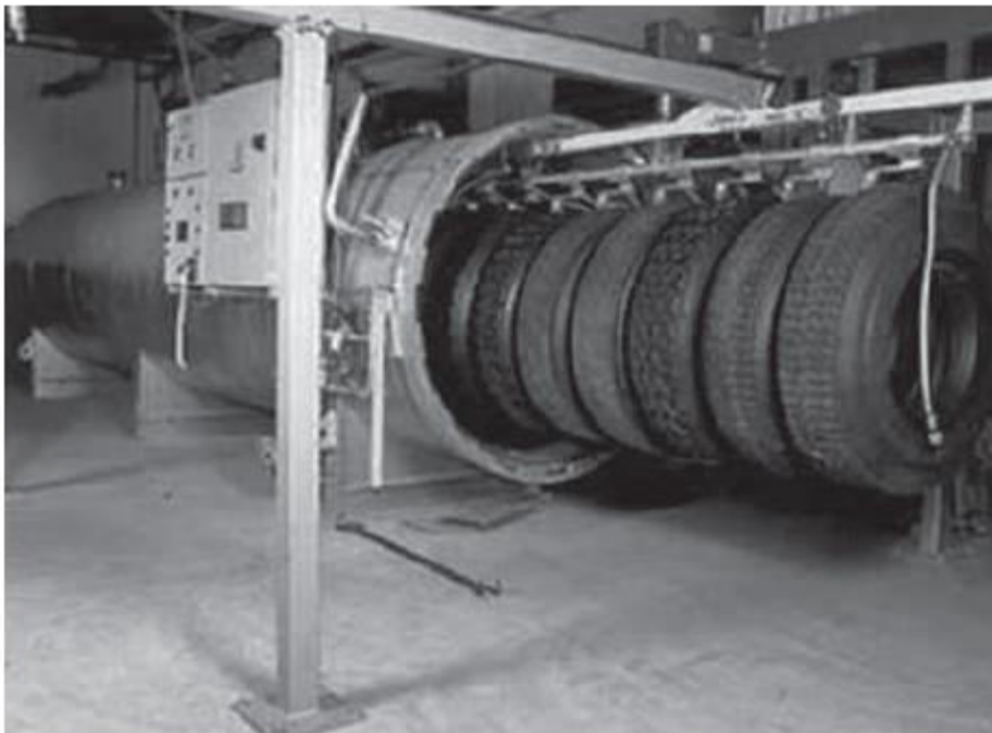
Figura 3,16 cámara de vulcanización para el sistema de curado en frío. El método de curado en frío es más simple que el sistema de curado en caliente y requiere menos inversión, pero sus costos materiales son más altos.
