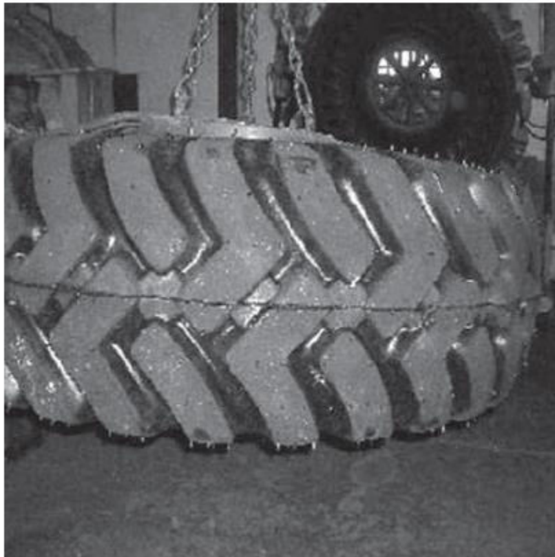
Figura 3,13 recauchutado moldeada para un neumático del volquete de 35 toneladas
