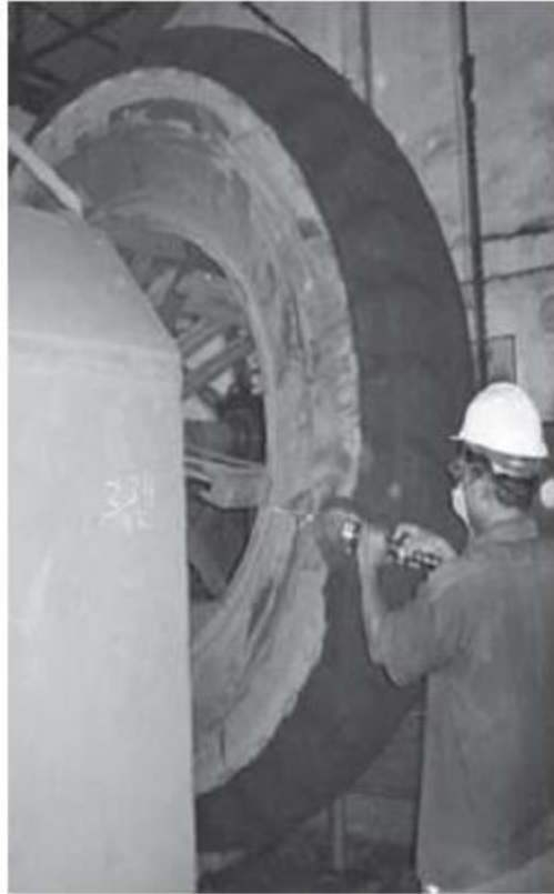
Figura 3,6 rectificado a mano de imperfecciones sobre una superficie de neumático
