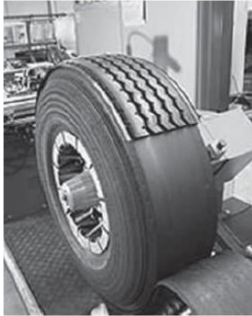
Figura 3,14 aplicación de la banda de rodadura precurada en un neumático
