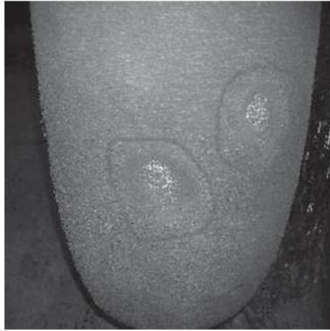
Figura 3,8 abolladuras que necesitan la reparación
