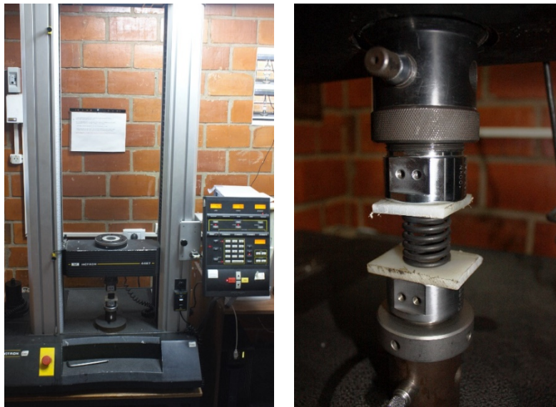
Figura 43. Ensayo de resortes.
