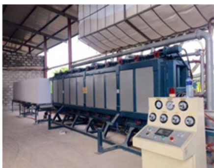
Figura 11: Fotografía de máquina de moldeo continuo y sus especificaciones técnicas Fuente: Elaboración propia en base a comunicación con empresa fabricante de equipos, 2019
