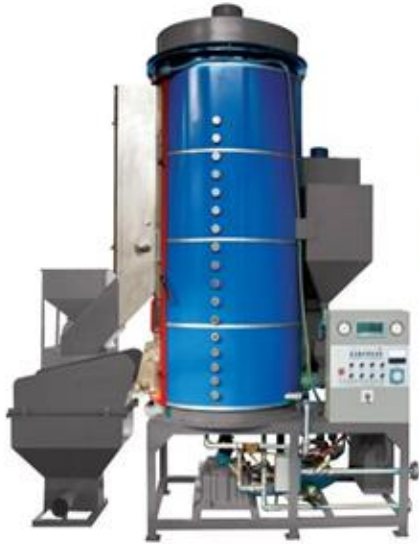
Figura 9: Esquema de pre-expansor continuo y sus especificaciones técnicas Fuente: Elaboración propia en base a comunicación con empresa fabricante de equipos, 2019
