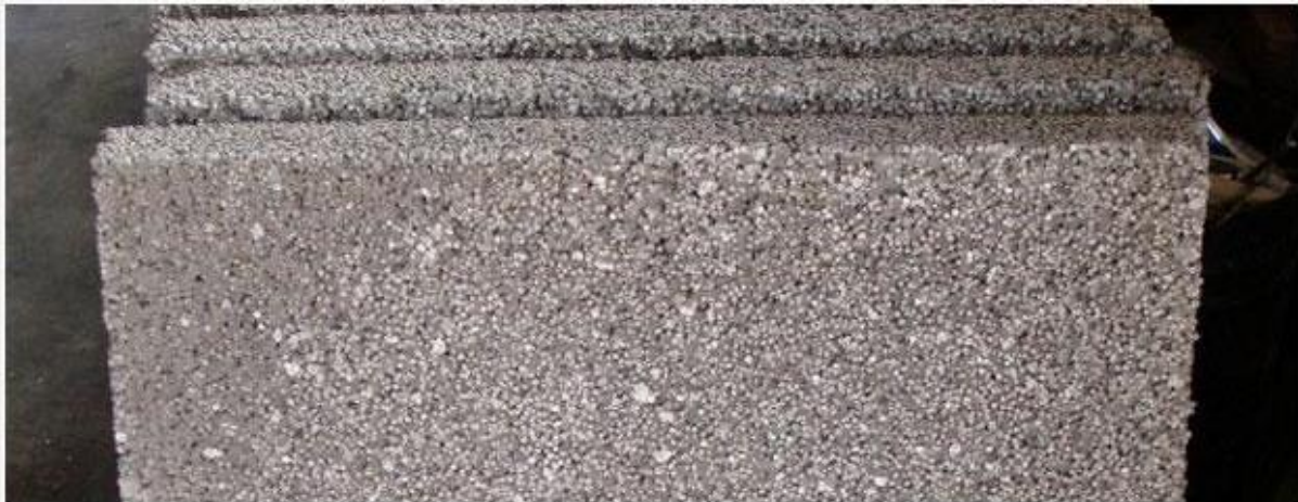
Figura 7: Fotografía de bloques de hormigón alivianado con granulado Fuente: Grupo Estisol, 2019
