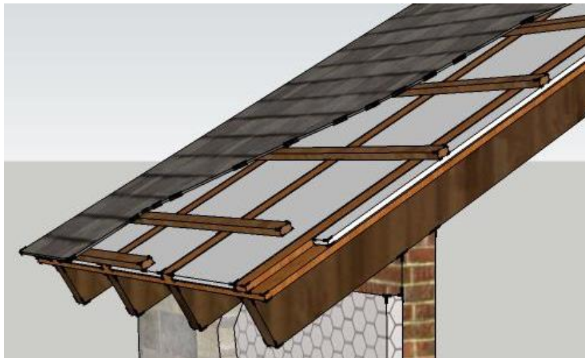
Figura 3: Esquema de planchas utilizadas en techos de teja o chapa Fuente: Grupo Estisol, 2019
