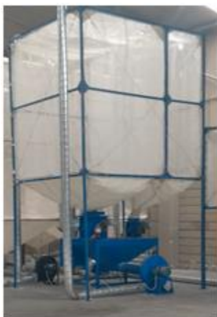
Figura 14: Fotografía de mezcladora y sus especificaciones técnicas Fuente: Elaboración propia en base a comunicación con empresa fabricante de equipos, 2019
