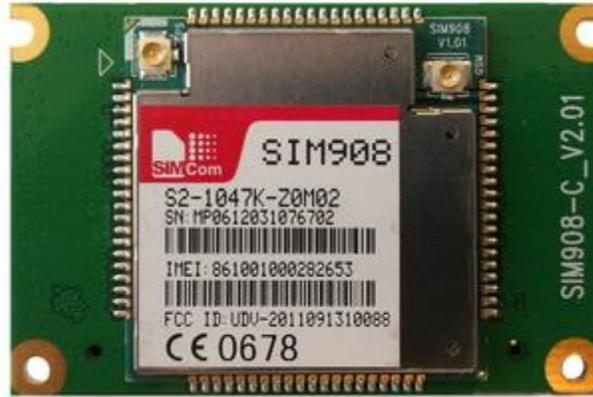
Figura III.4 – Módulo SIM908-C
