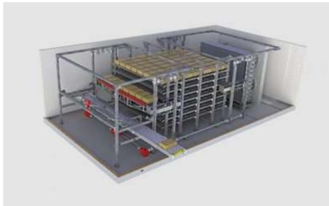
Figura 2. Túnel de refrigeración de retención variable
