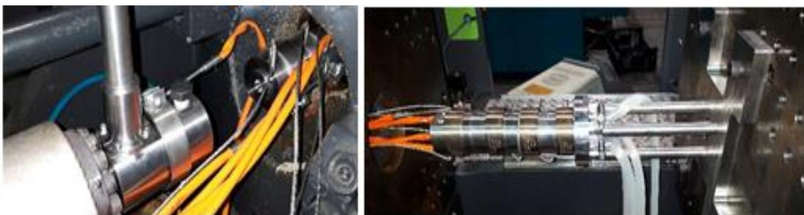
**Figura 16.** Esquema (a) e imagen (b) del reómetro capilar unido a la unidad de inyección de la máquina de moldeo por inyección.
