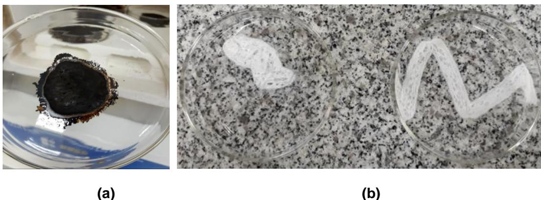
**Figura 9.** Pirólisis del polímero en la Mufla a 600 °C durante, a) 60 min, b) 6 horas.
