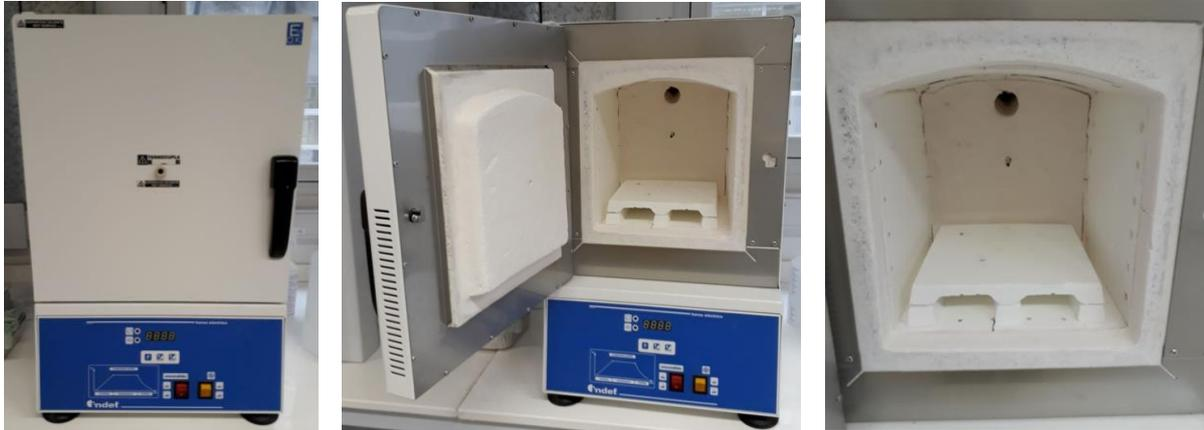
**Figura 8.** Horno eléctrico (Mufla).
