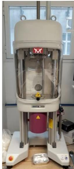
**Figura 14.** Reómetro Capilar Convencional INSTRON SR50.
