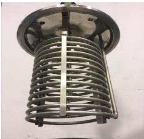
**Figura 51** - Serpentin soldado al techo del reactor.
