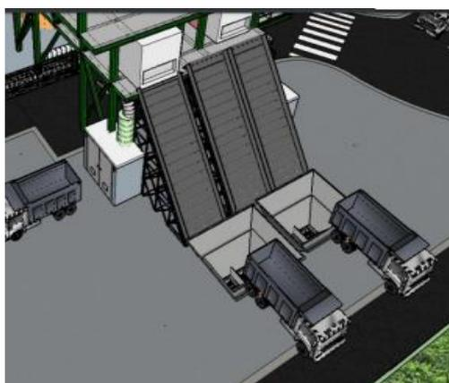
**Figura 35** - Camión descargando a tolva.
