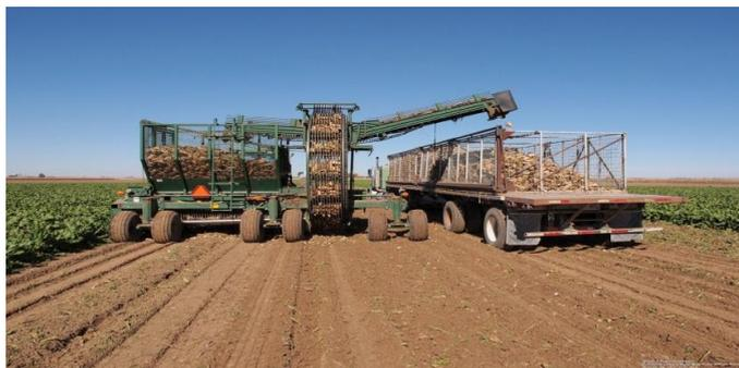
**Figura 32-** Máquina cosechadora de remolacha azucarera.
